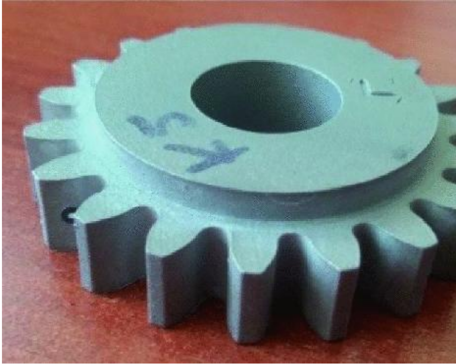
Σχήμα 47. Οδοντωτός τροχός που κατασκευάστηκε με τη μέθοδο DMLS μετά τη διαδικασία αμβολής [60]
