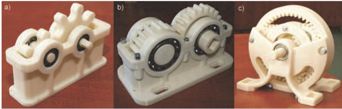
Σχήμα 9. Εργαλεία κατασκευασμένα με τη μέθοδο FDM: a) γρανάζια μονής βαθμίδας με τροχούς κυκλοειδούς προφίλ, b) γρανάζια μονής βαθμίδας με τροχούς εξειλιγμένης, c) πλανητικός μηχανισμός
