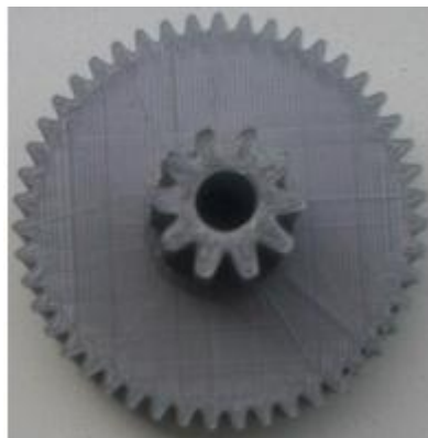
Σχήμα 32. Κάτω μέρος οδοντωτού τροχού τρισδιάστατης εκτύπωσης με πάχος γραμμής: 0,5 mm [15]
