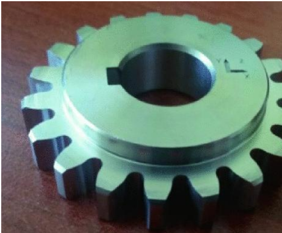
Σχήμα 48. Οδοντωτός τροχός που κατασκευάστηκε με τη μέθοδο DMLS μετά την αποπερατική μηχανουργική κατεργασία [60]
