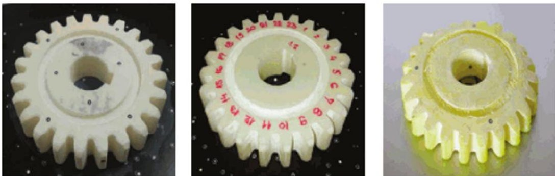
Σχήμα 43. Οδοντωτός τροχός από ABS τυπωμένος οριζόντια (αριστερά), οδοντωτός τροχός από ABS τυπωμένος κατακόρυφα (κέντρο) και οδοντωτός τροχός από PA τυπωμένος οριζόντια (δεξιά) [58]
