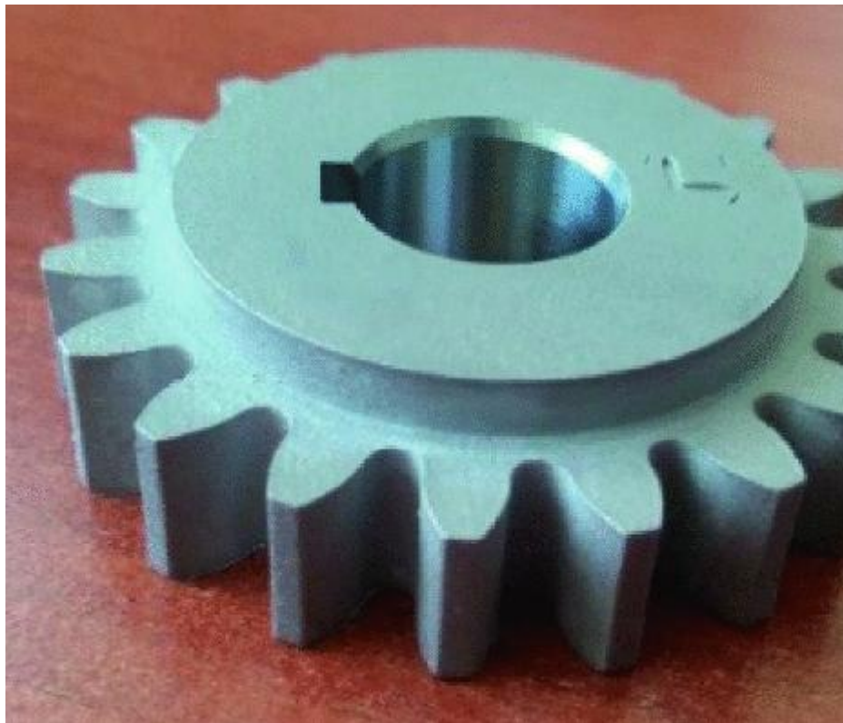
Σχήμα 46. Οδοντωτός τροχός που κατασκευάστηκε με τη μέθοδο DMLS μετά την αφαίρεση των δομών στήριξης [60]
