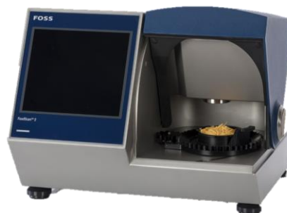
Εικόνα 15.: Όργανο ανάλυσης σύστασης γαλακτοκομικών προϊόντων FoodScan
