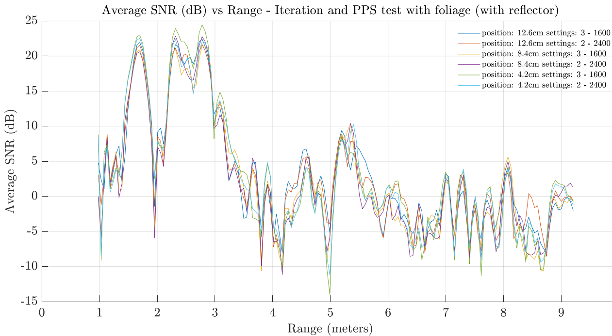
Εικόνα 3.50 Λόγος σήματος προς θόρυβο δοκιμαστικών μετρήσεων των συνδυασμών iterations – pps, σε φύλλωμα, με ανακλαστήρα παρουσία ανθρώπου στα 5.3m.
