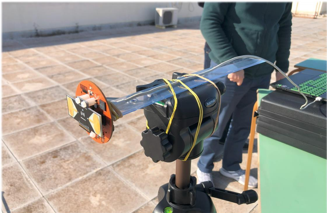
Εικόνα 3.12 Στήριξη πλακέτας – ραντάρ εκτός βάσης
