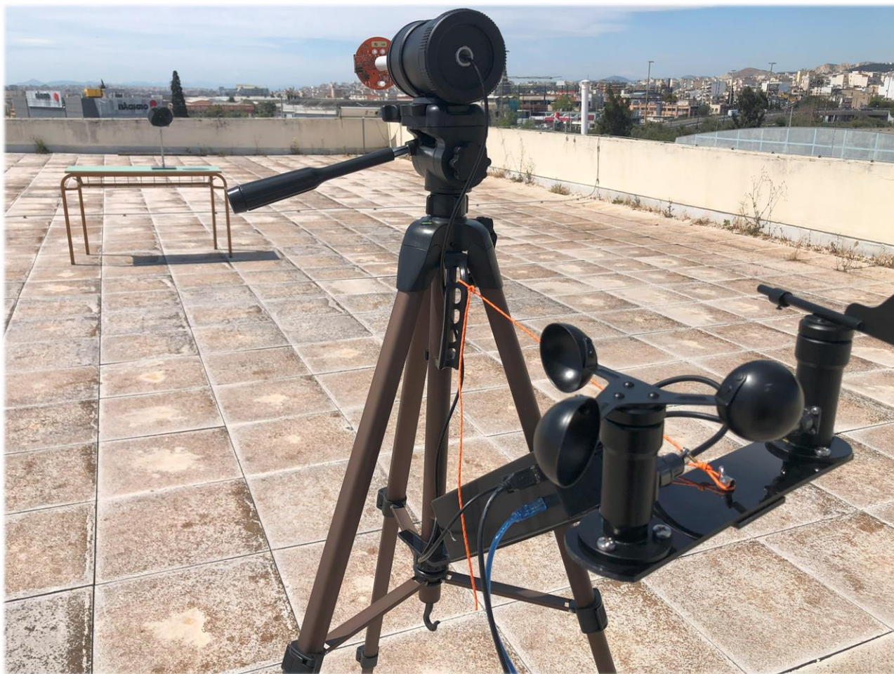
Εικόνα 3.25 Προσωρινή τοποθέτηση ανεμομέτρων – έλεγχος πιθανότητας παρεμβολών θέσης.
