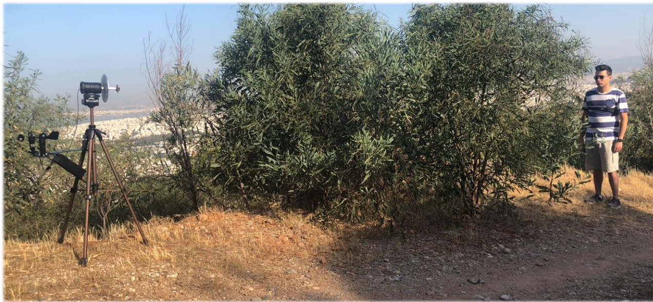
Εικόνα 3.43 Παράδειγμα χωρικής διάταξης δοκιμαστικής μέτρησης επαλήθευσης συνδυασμών iterations – pps σε φύλλωμα με ανακλαστήρα, παρουσία ανθρώπου.
