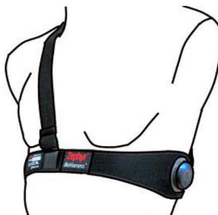
Εικόνα 3.5 Παράδειγμα τοποθέτησης της ζώνης. Πηγή: [25]
