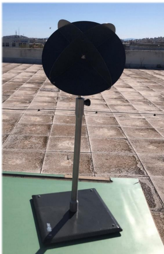
Εικόνα 3.19 Μεταλλικός στόχος δοκιμών ραντάρ τύπου αστέρα, της εταιρίας Lab-Volt.
