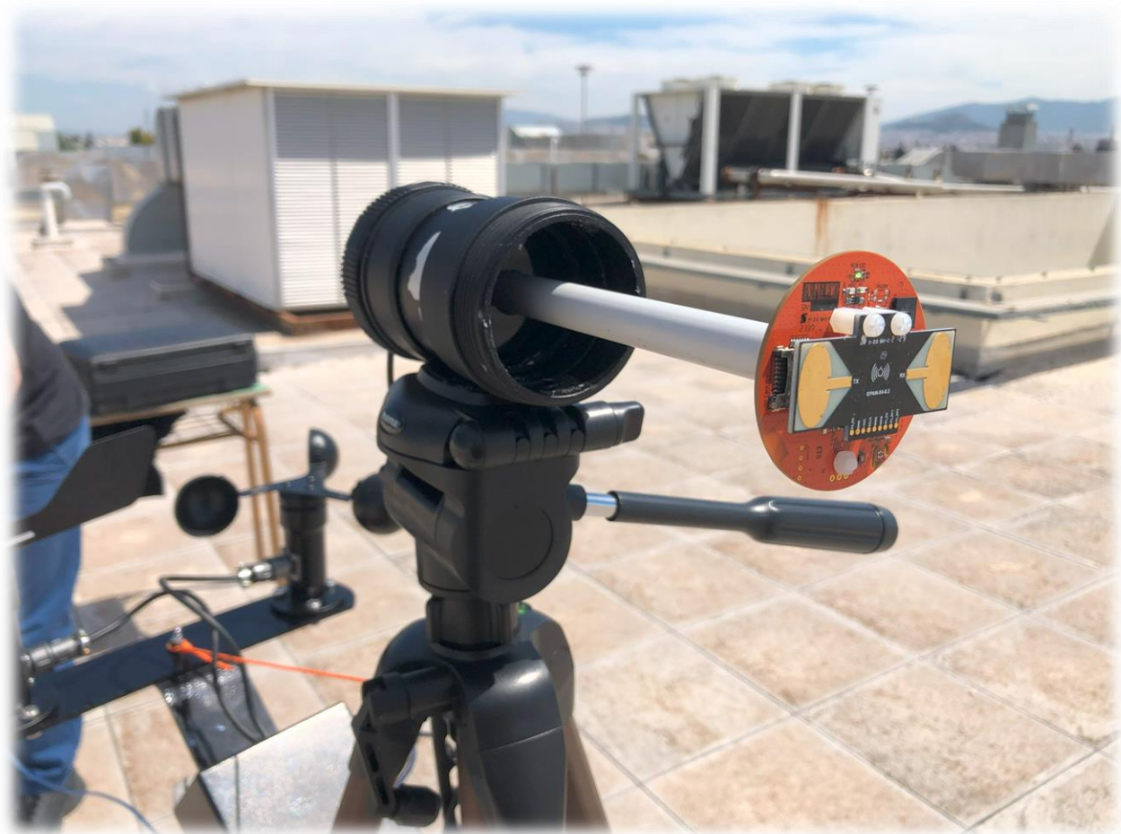
Εικόνα 3.29 Τροποποίηση κατασκευής με προσαρμογή κεντρικού άξονα μετακίνησης ραντάρ εντός και εκτός θήκης.
