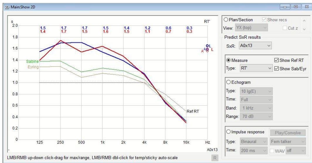
Εικόνα 15: Χρόνος αντήησης σε διάφορα σημεία με ακροατές χωρίς παρεμβάσεις.
