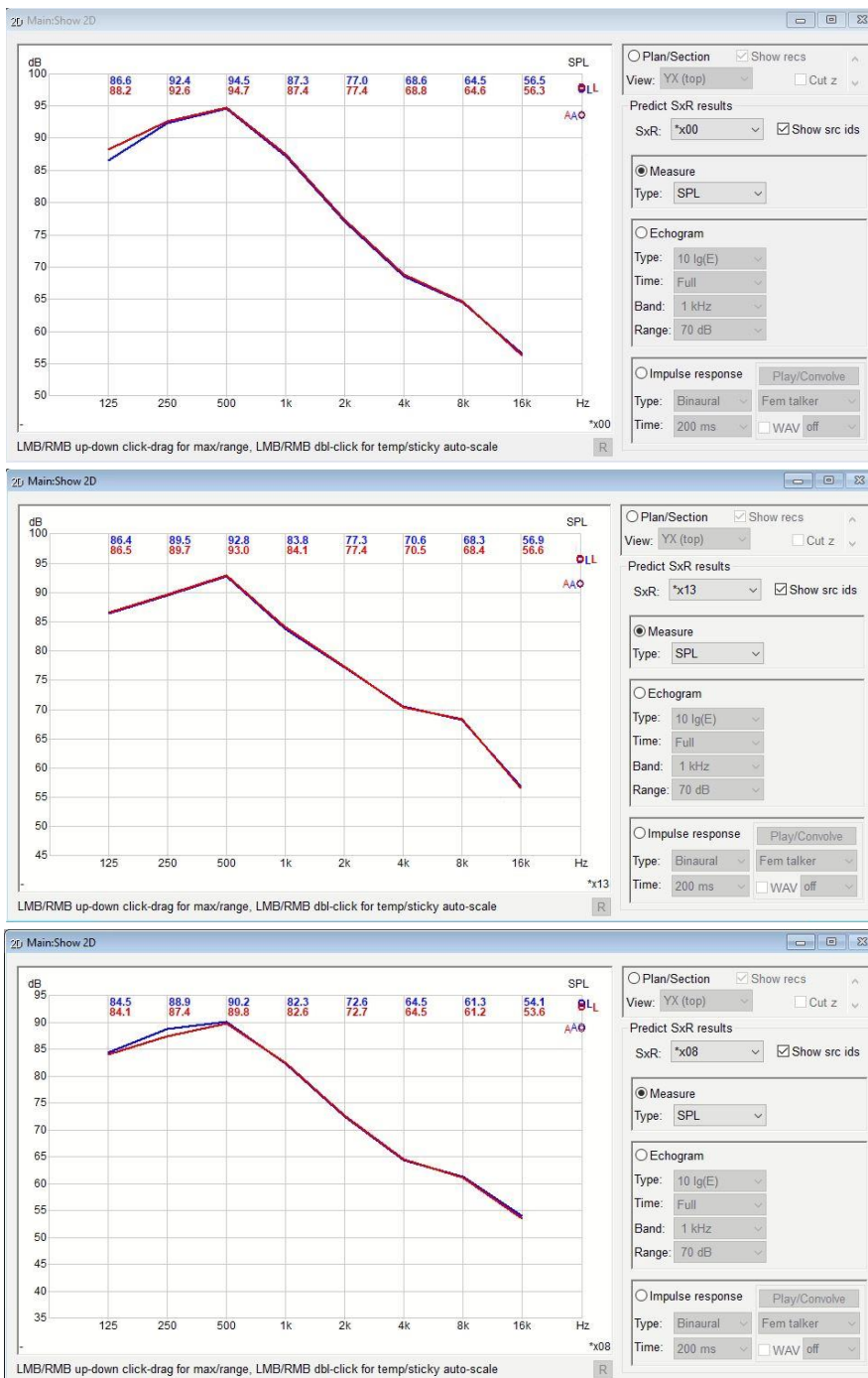
Εικόνα 30: Στάθμη ακουστικής πίεσης (SPL) στις θέσεις ακροατών Α,Β,Γ αντίστοιχα μετά από ηλεκτροακουστική μελέτη.
