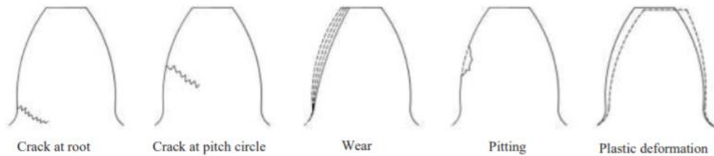
Σχήμα 41. Διαφορετικοί τρόποι φθοράς των οδόντων ενός οδοντωτού τροχού [12]
