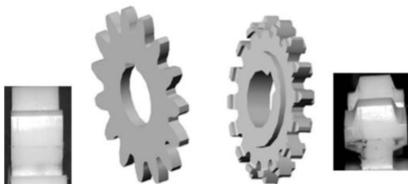
Σχήμα 28. Πειραματικοί οδοντωτοί τροχοί, (αριστερά) ο μη τροποποιημένος οδοντωτός τροχός και (δεξιά) ο τροποποιημένος οδοντωτός τροχός [6]
