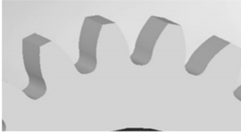
Σχήμα 29. Κανονικός οδοντωτός τροχός χωρίς σπές ψύξης [7]
