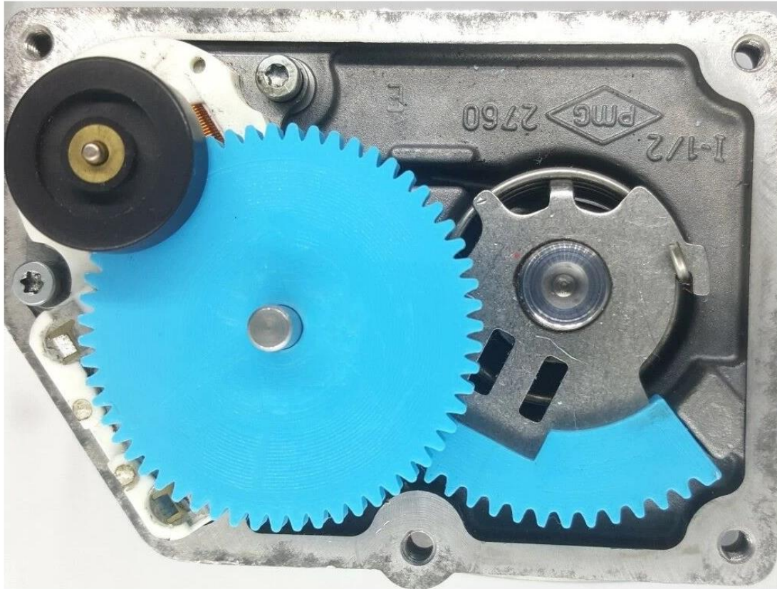
Σχήμα 14. Ο εσωτερικός μηχανισμός του ηλεκτρονικού ενεργοποιητή της πεταλούδας γκαζιού με πολυμερικούς οδοντωτούς τροχούς από νάιλον ενισχυμένο με 20% ίνες άνθρακα. [42]
