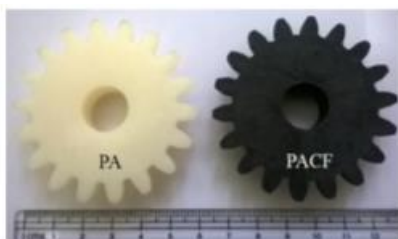
Σχήμα 47. Οδοντωτοί τροχοί από PA και PACF [53]
