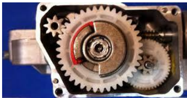
Σχήμα 8. Ο ηλεκτρονικός ενεργοποιητής χειρόφρενου της bmw 7 series (για τα μοντέλα 2002-2008) [33]
