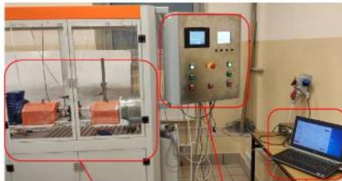
Σχήμα 71. Διάταξη για δοκιμές πολυμερικών οδοντωτών τροχών [66]
