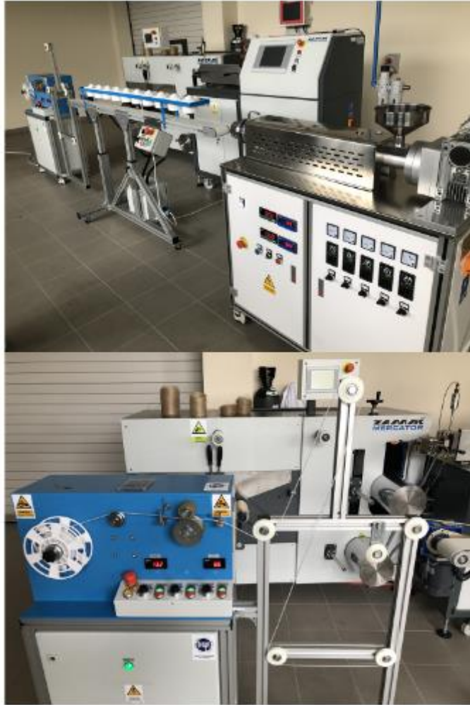
Σχήμα 70. Η πρωτότυπη γραμμή παραγωγής νήματος σχεδιασμένη για την έρευνα [66]
