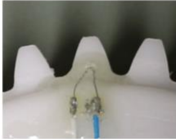
Σχήμα 37. Θερμικός αισθητήρας μέτρησης της θερμοκρασίας των οδόντων [10]
