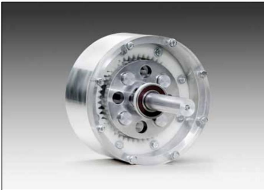
Σχήμα 82. Το κιβώτιο μετάδοσης του Ultra Light Urban Vehicle (ULUV) [77-78]
