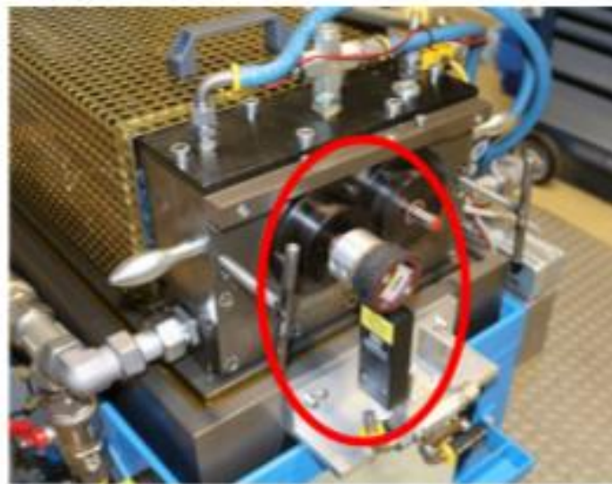
Σχήμα 38. Επαγωγικό σύστημα τηλεμετρίας για μέτρηση της θερμοκρασίας των οδόντων [10]
