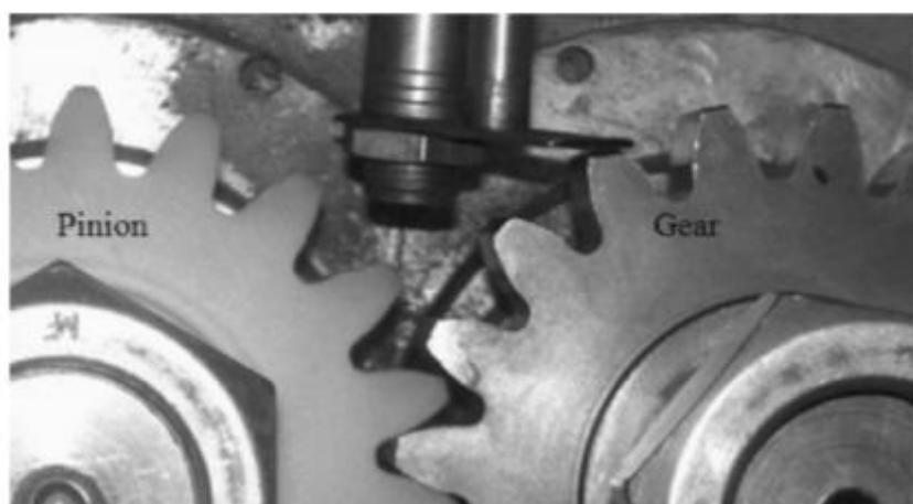
Σχήμα 39. Μέτρηση της θερμοκρασίας της επιφάνειας των οδόντων [11]
