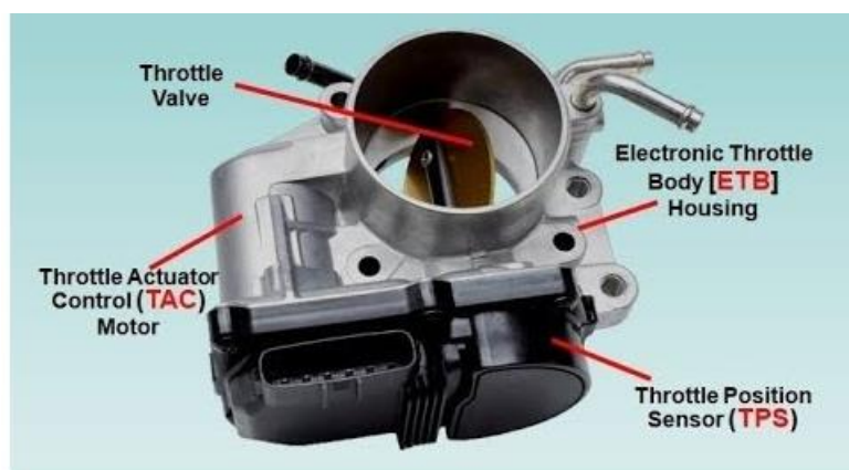
Σχήμα 13. Ο ηλεκτρονικός ενεργοποιητής της πεταλούδας γκαζιού [41]
