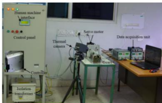
Σχήμα 45. Πειραματική διάταξη ελέγχου αντοχής οδοντωτών τροχών [53]
