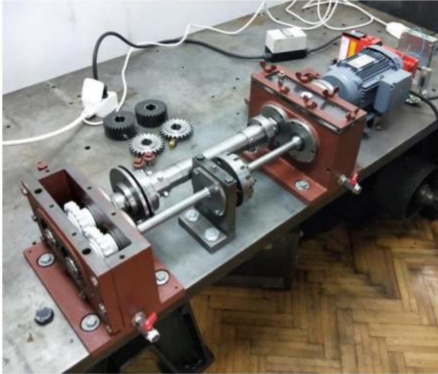
Σχήμα 24. Διάταξη πειραματικού ελέγχου οδοντωτών τροχών [4]
