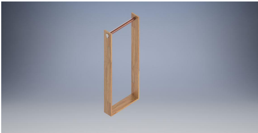
Εικόνα 3-3: Σχέδιο τελικής κατασκευής εκκρεμούς
