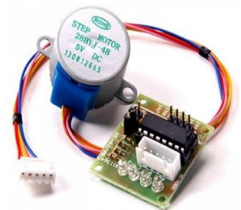
Εικόνα 1-10 : Βηματικός κινητήρας (Stepper motor & driver)
