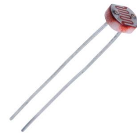
Εικόνα 1-6 : Φωτοαντίσταση (αισθητήρας φωτός)
