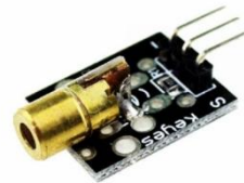
Εικόνα 1-13: Red Laser Transmitter Module KY-008
