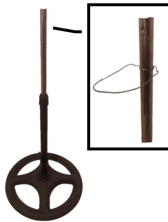
Εικόνα 3-11: Στήριξη της κατασκευής και η υποδοχή για το σώμα
