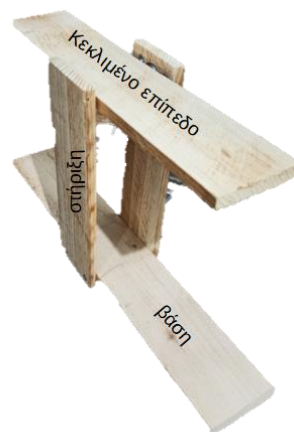
Εικόνα 2-3 : Περιγραφή κατασκευής μελέτης τριβής
