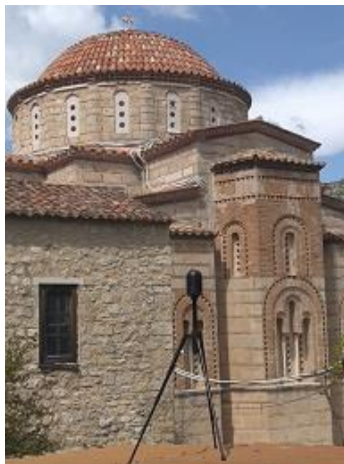
Εικόνα 95. Εξωτερική υπερυψωμένη θέση σάρωσης.
