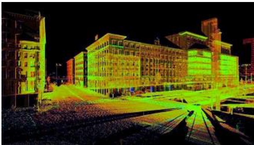
Εικόνα 61. Νέφος σημείων (point cloud) χωρίς χρωματική πληροφορία (Orbital Africa Ltd, Kenya, 2022).
