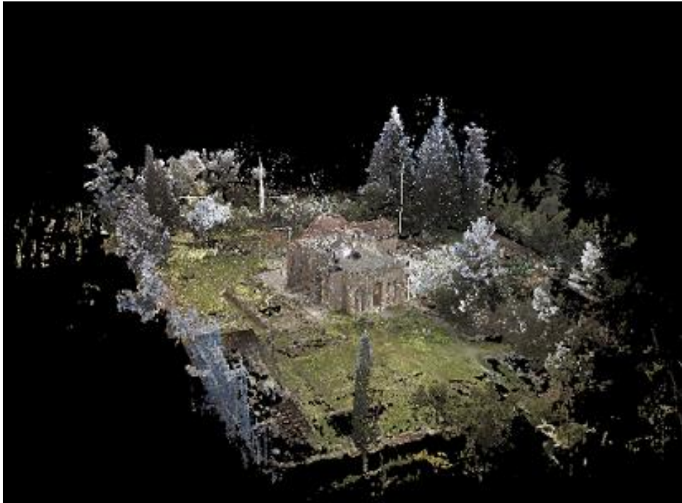
Εικόνα 116. Συνενωμένο νέφος σημείων με χρωματική πληροφορία της Μονής Δαφνίου και του περιβάλλοντα χώρου
