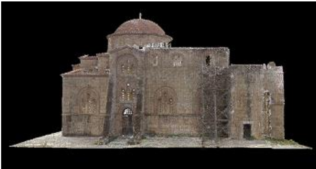
Εικόνα 120. Τελικό νέφος σημείων απαλλαγμένο από την περιττή πληροφορία.
