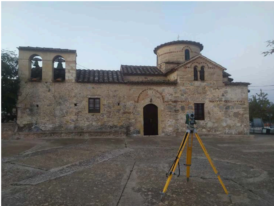
Εικόνα 32: Total Station Sokkia Set 50x με φόντο τον Ναό.
