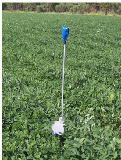
Εικόνα 3.18: Κόμβος έξυπνου μετρητή με υψωμένο πομπό σε χωράφι φιστικιών [58]
