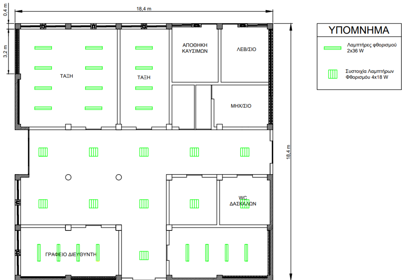
Εικόνα 35: Θέσεις Λαμπτήρων - Ισόγειο Κτιρίου 2 (Κ2)
