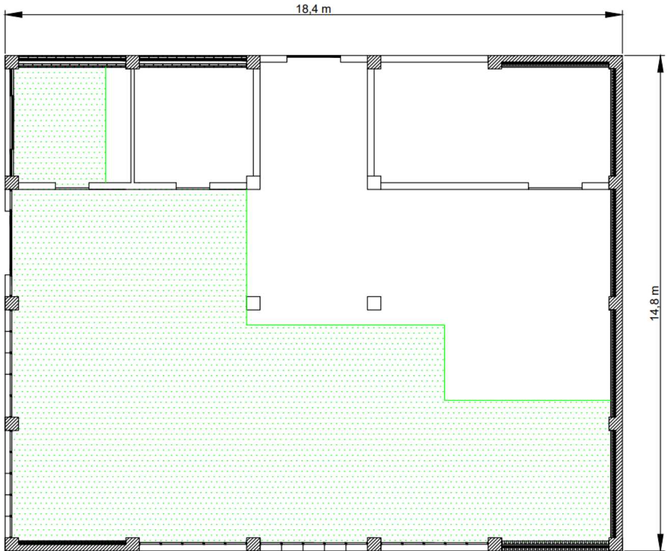
Εικόνα 41: Ζώνες Φυσικού Φωτισμού - Ισόγειο Κτιρίου 3 (Κ3)
