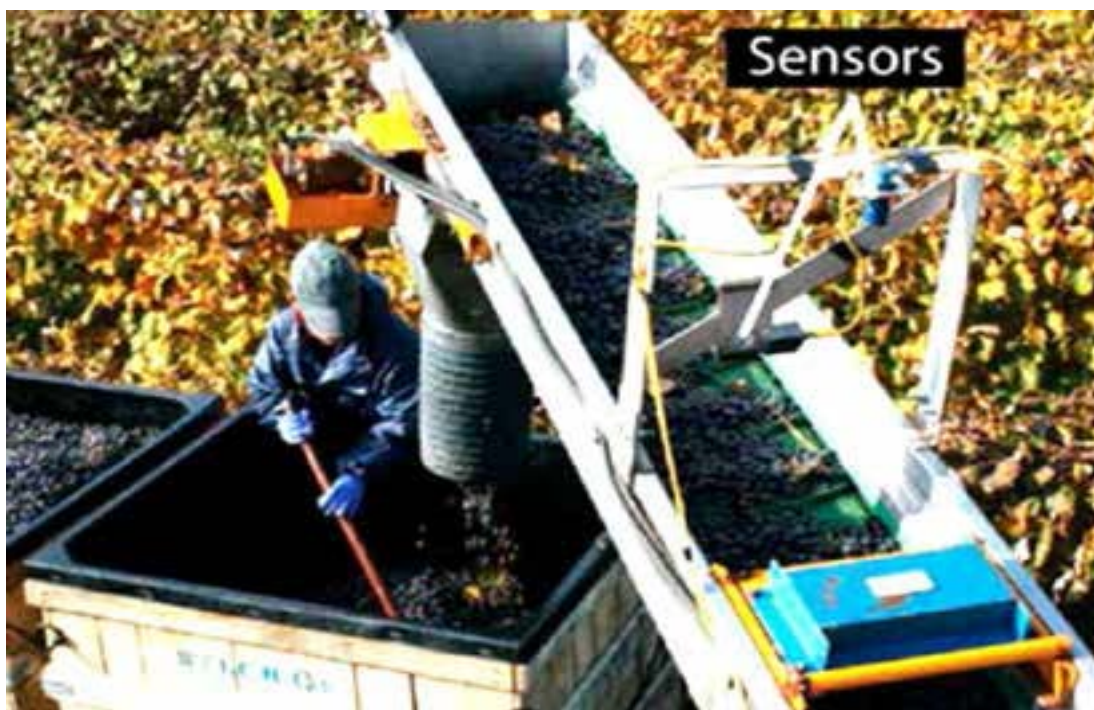
Εικ.2.9: Σύστημα μέτρησης ροής σταφυλιών εκτίμησης όγκου με χρήση υπερήχων [13]
