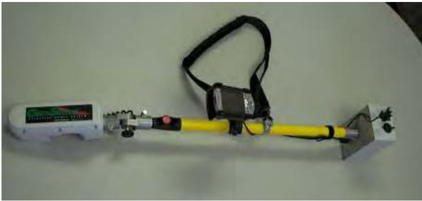
Εικόνα 2.3: Αισθητήρας που χρησιμοποιεί τον δείκτη NDVI [9]
