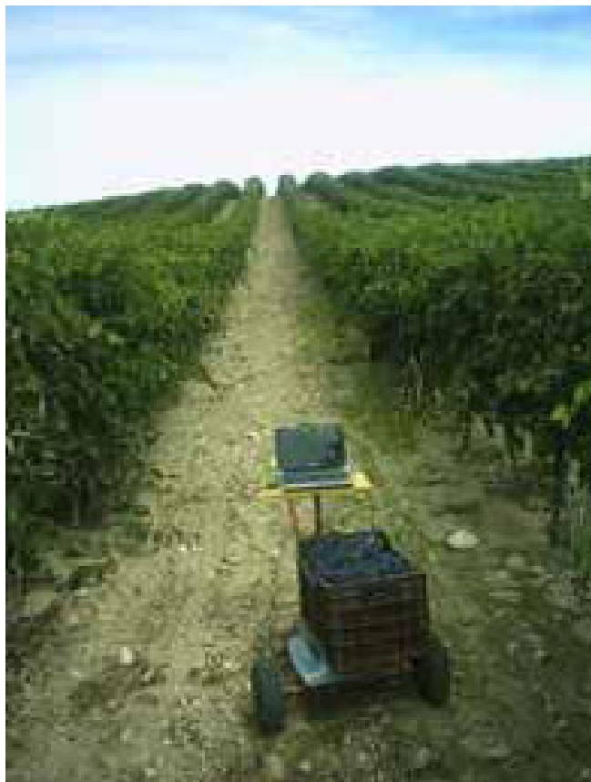
Εικ.2.12: Αμαξίδιο με GPS, ηλεκτρονικό ζυγό και φορητό υπολογιστή[10]
