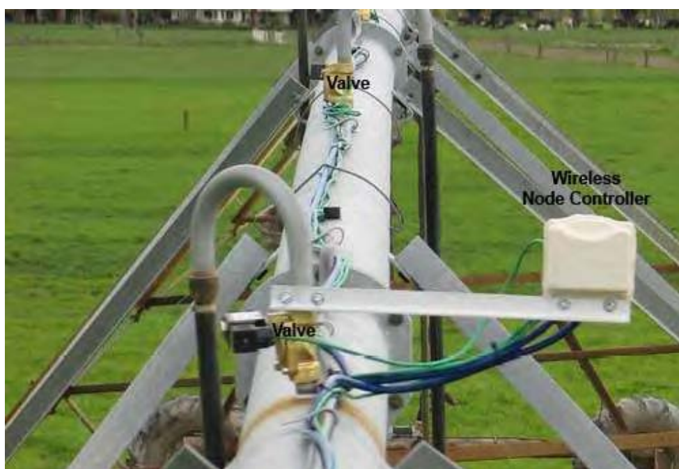
Εικ.2.6 Σύστημα εφαρμογής μεταβλητή άρδευσης [9]
