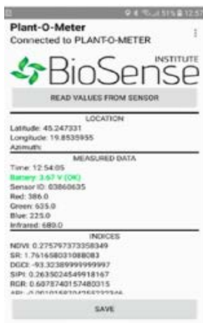
Εικ. 2.4: Πολυφασματικός οπτικός αισθητήρας γεωργικής χρήσης
