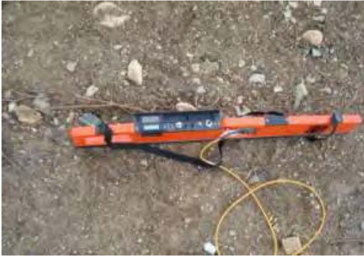
Εικόνα 2.1: Αισθητήρας ηλεκτρικής αγωγιμότητας EM38
