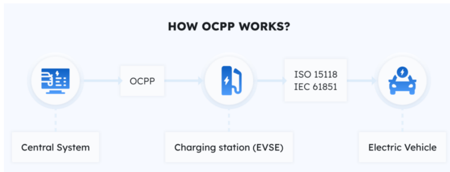
Εικόνα 11. Πρωτόκολλα επικοινωνίας σταθμών φόρτισης ηλεκτρικών οχημάτων [39].
