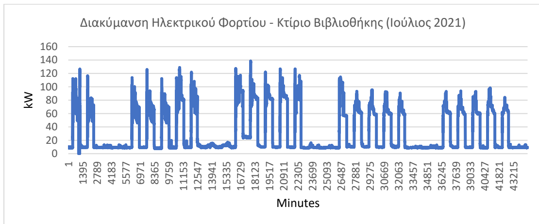
Γράφημα 35: Ελάχιστο ηλεκτρικό φορτίο – Κτίριο Βιβλιοθήκης (Ιούλιος 2021)
