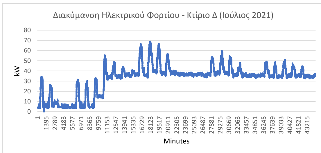
Γράφημα 30: Ελάχιστο ηλεκτρικό φορτίο – Κτίριο Δ (Ιούλιος 2021)
