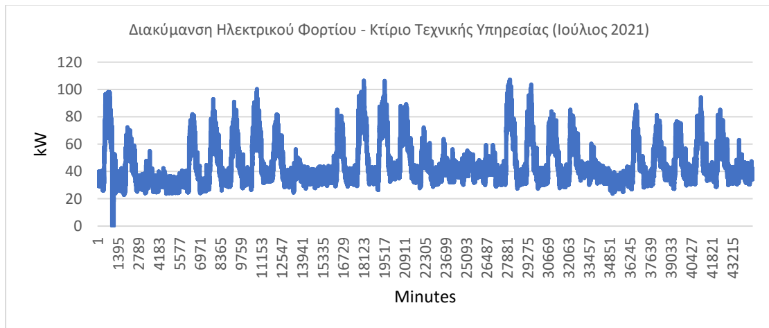
Γράφημα 37: Ελάχιστο ηλεκτρικό φορτίο – Κτίριο Τεχνικής Υπηρεσίας (Ιούλιος 2021)
