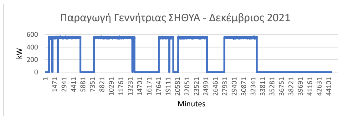
Γράφημα 20: Διακόμανση παραγωγής γεννήτριας μονάδας ΣΗΘΥΑ Πα.Δ.Α. (Δεκέμβριος 2021)
