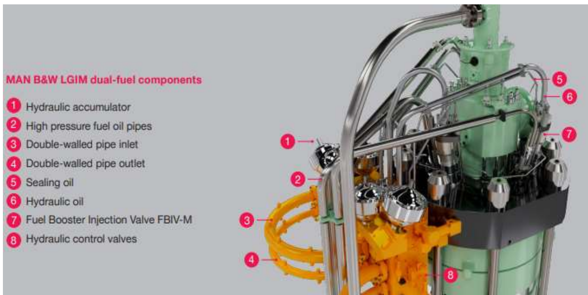
Εικόνα 29 : Μέρη κινητήρα ME-LGIM (Πηγή : MAN)
