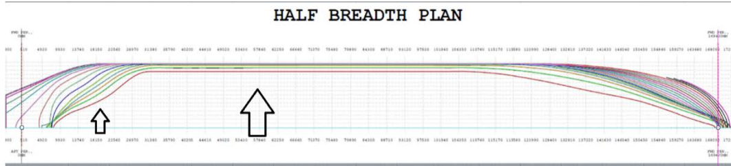
Εικόνα Π.2 - 69: Η πρώτη ισάλος θα είναι η Waterline 1 με το κόκκινο χρώμα
