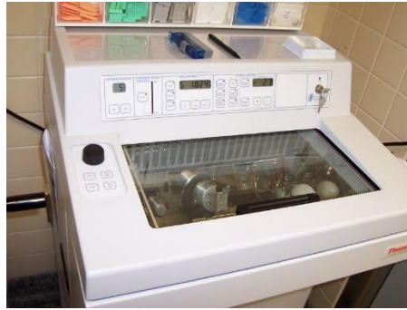
Εικόνα 2.10. Κρυοστάτης μικρότομος (Πηγή 19 ).
