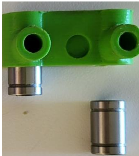
Εικόνα 4.4. Βάση στήριξης με τα γραμμικά ρουλεμάν.
