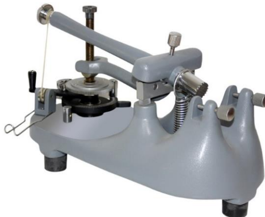
Εικόνα 2.7. Παλινδρομική μικροτόμος (Πηγή 16 ).
