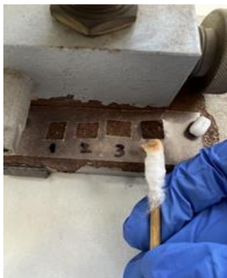
(εικ.29) Συσκευή Boyle - Mariotte, δοκιμές καθαρισμού σημείο 1, Τμήμα Συντήρησης Αρχαιοτήτων και Έργων Τέχνης ΠΑ.Δ.Α., Βασιλεία Τρίττα
