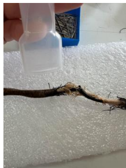
(εικ.50) Καλώδιο γεννήτριας ακουστικών συχνοτήτων, εfügρανση ινών, Τμήμα Συντήρησης Αρχαιοτήτων και Έργων Τέχνης ΠΑ.Δ.Α., Βασιλεία Τρίττα
