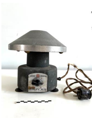
(εικ.45) Συσκευή φυγοκέντρωσης, Τμήμα Συντήρησης Αρχαιοτήτων και Έργων Τέχνης ΠΑ.Δ.Α., Βασιλεία Τρίττα
