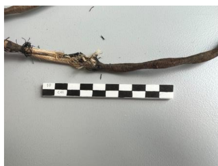
(εικ.47) Σημείο ινών στο καλώδιο γεννήτριας ακουστικών συχνοτήτων, Τμήμα Συντήρησης Αρχαιοτήτων και Έργων Τέχνης ΠΑ.Δ.Α., Βασιλεία Τρίττα
