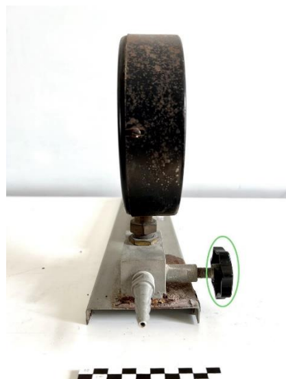
(εικ.27) Συσκευή Boyle - Mariotte, πλαστικό τμήμα, Τμήμα Συντήρησης Αρχαιοτήτων και Έργων Τέχνης ΠΑ.Δ.Α., Βασιλεία Τρίττα
