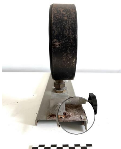
(εικ.28) Συσκευή Boyle - Mariotte, προϊόντα διάβρωσης, Τμήμα Συντήρησης Αρχαιοτήτων και Έργων Τέχνης ΠΑ.Δ.Α., Βασιλεία Τρίττα
