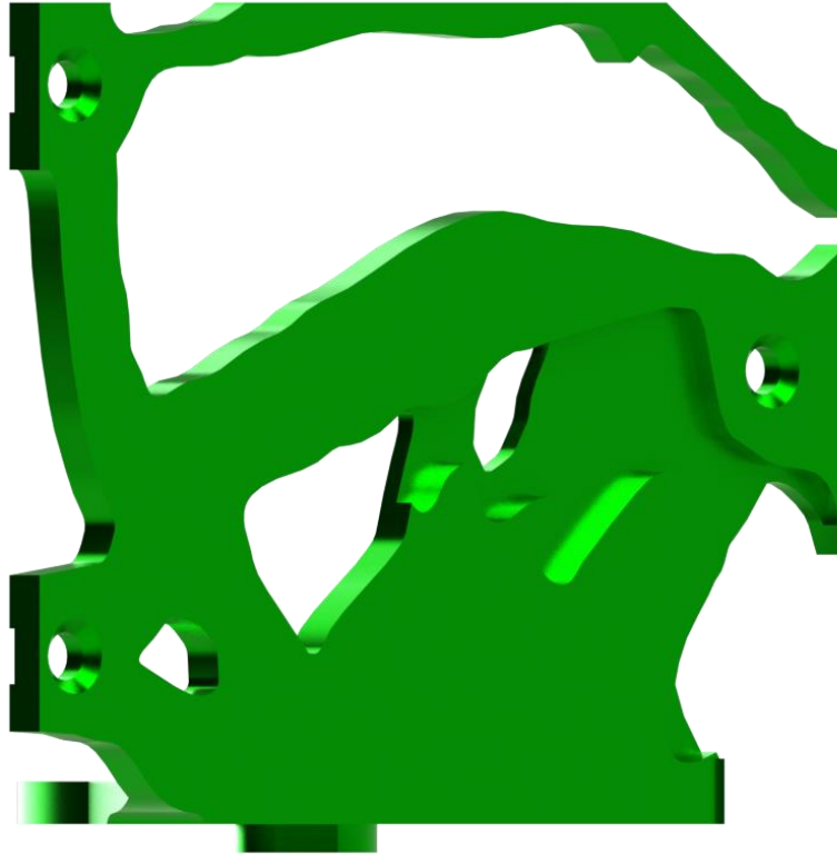
Εικόνα 3: Τοπολογική βελτιστοποιημένη βάση για 5-αξονική μηχανή CNC.
