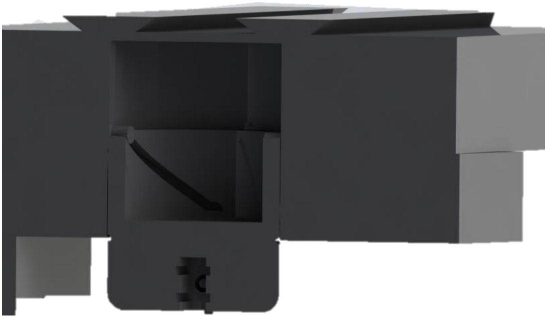
Εικόνα 4: Σύστημα bayonet για κλείδωμα στο pan
