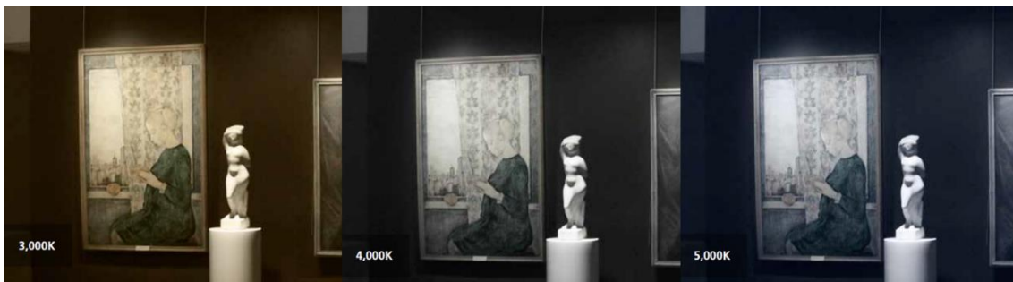
Εικόνα 1-7 Φωτισμός τονισμού με διαφορετικές θερμοκρασίες χρώματος. (Πηγή : www.sylvania.com ) (Ημερομηνία τελευταίας ανάκτησης : 27 /11/22)
