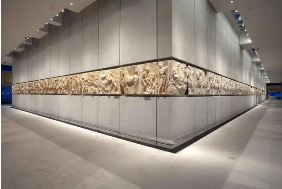
Εικόνα 7-24 Εσωτερική άποψη της κατακόρυφης επιφάνειας παρουσίασης των μαρμάρων της ζωφόρου. Τις βραδινές ώρες ο φωτισμός ανάδειξης πραγματοποιείται μέσω wallwashers που προσφέρουν ομοιόμορφο φωτισμό, υπό γωνία σχεδόν κατακόρυφη με τον κατακόρυφο άξονα. (πηγή : www.theacropolismuseum.gr ) (Ημερομηνία τελευταίας ανάκτησης : 14/05/22)
