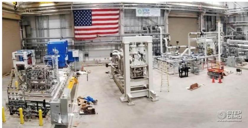
Σχήμα 2.22: Έμμεσα θερμαινόμενο σύστημα παραγωγής υψηλής θερμοκρασίας s-CO 2 STEP.
