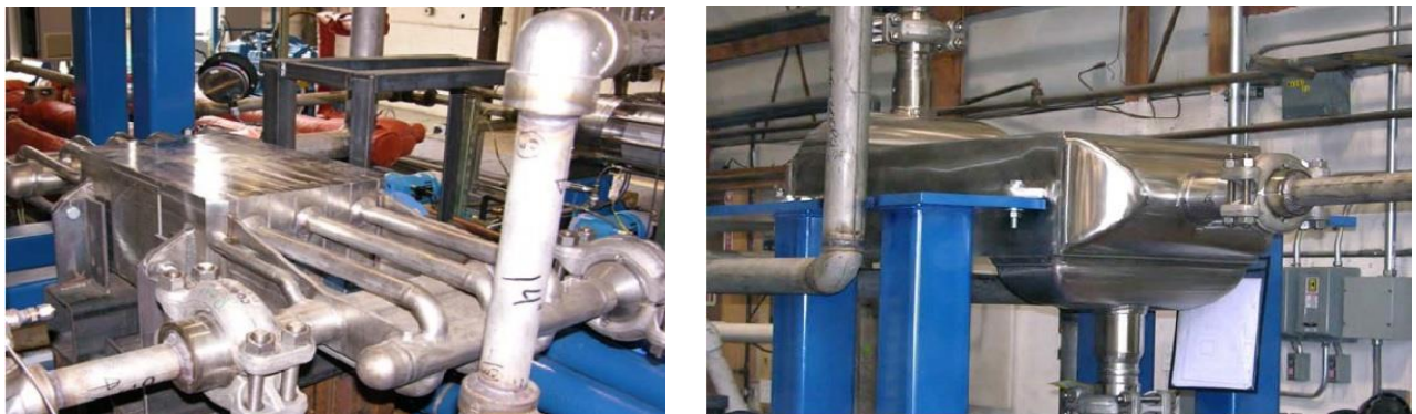
Σχήμα 2.34: Εναλλάκτης θερμότητας PCHE χαμηλής θερμοκρασίας s-CO 2 , LTR (αριστερά) και εναλλάκτης θερμότητας PCHE υψηλής θερμοκρασίας s-CO 2 , HTR (δεξιά).
