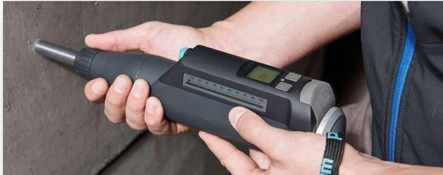
Εικόνα 10: Μη Καταστροφική Μέθοδος Κρουσιμέτρησης
