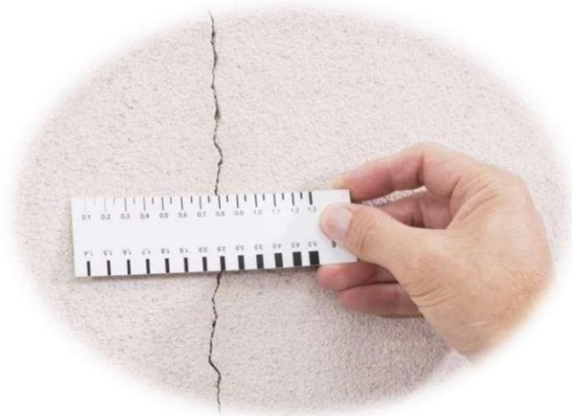
Εικόνα 9: Προσδιορισμός Πλάτους Ρωγμής
