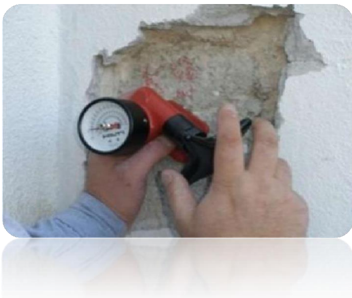
Εικόνα 14: Έλεγχος με Χρήση Εξολκέα
