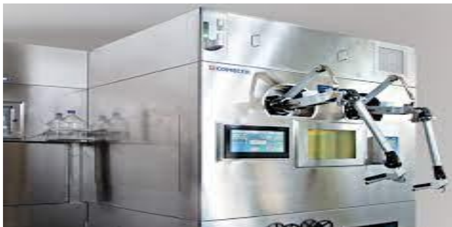
Εικόνα 4.25 Γεννήτρια τεχνητίου σε εργαστήριο πυρηνικής ιατρικής. Αποτελεί ένα αρκετά ογκώδες μηχάνημα λόγω της μολύβδινης θωράκισης της.
