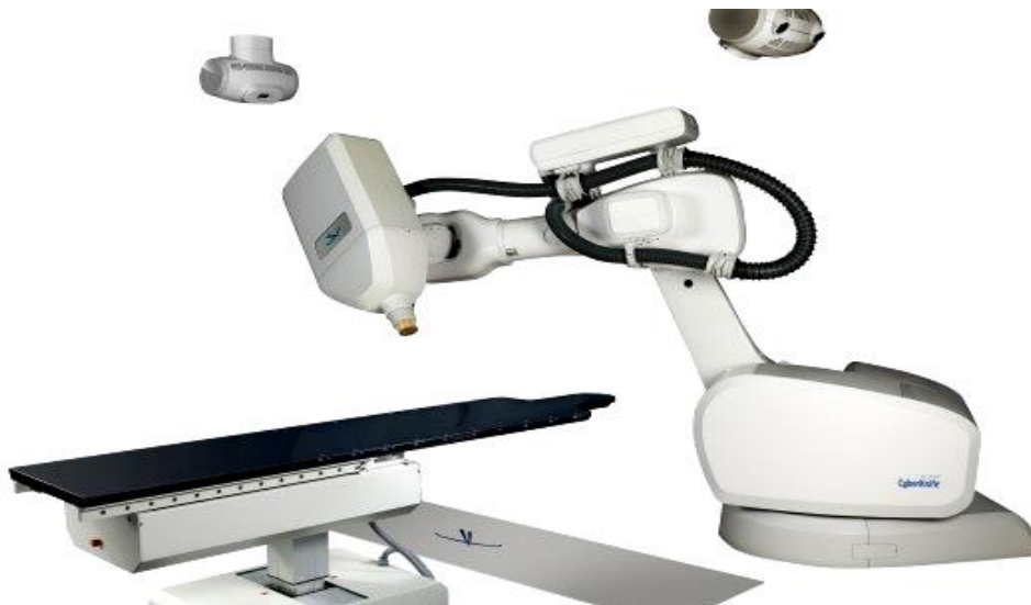
Εικόνα 2.8 Το cyber knife έχει την δυνατότητα να περιέχει ολόκληρη την διάταξη παραγωγής μικροκυμάτων και επιτάχυνσης των ηλεκτρονίων στην κεφαλή του η οποία προσαρμοσμένη στον βραχίονα στήριξης / κίνησης μπορεί να πραγματοποιήσει τρισδιάστατη ακτινοθεραπεία.
