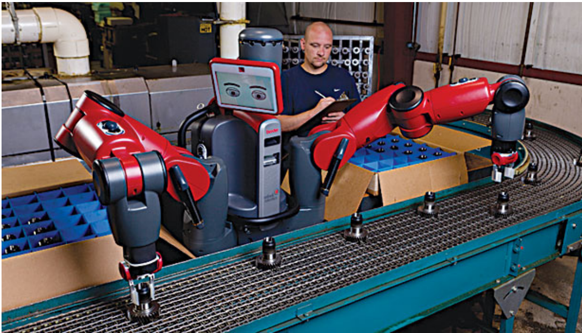
Εικόνα 2. Αυτό το ρομπότ χρησιμοποιεί κάμερες και αισθητήρες πίεσης για να εντοπίζει και να πιάνει αντικείμενα χωρίς να προσκρούει σε ανθρώπους. Φωτογραφία προσφορά της Rethink Robotics Inc.
