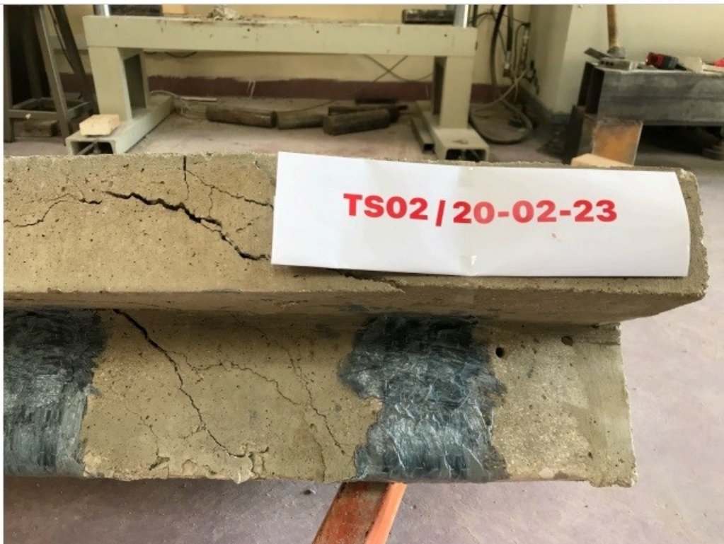
Εικόνα 6.4.1.17 Ρηγματώσεις που προκλήθηκαν στην πλακοδοκό (TS02)
