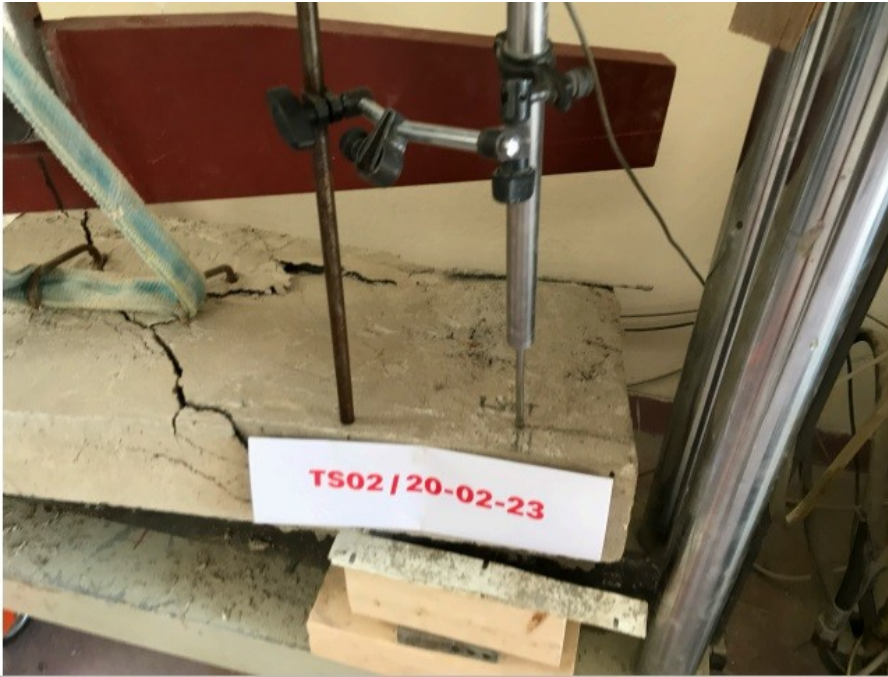
Εικόνα 6.4.1.16 Αποτελέσματα άσκησης φορτίου σε πλακοδοκό (TS02)
