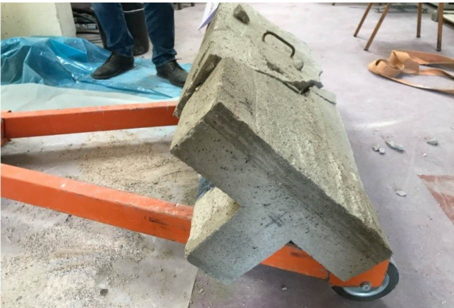
Εικόνα 6.4.1.10 Αστοχία δοκιμίου TS01 έπειτα από φόρτιση (1 ο πείραμα)
