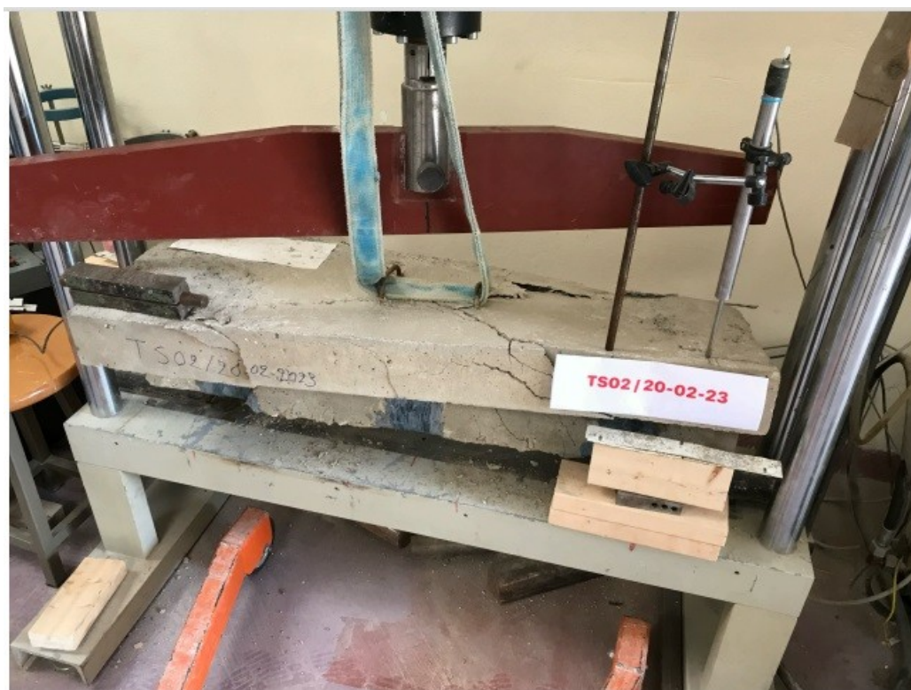
Εικόνα 6.4.1.15 Εφαρμογή φορτίου σε πλακοδοκό (TS02) 2ο πείραμα 20/2/2023
