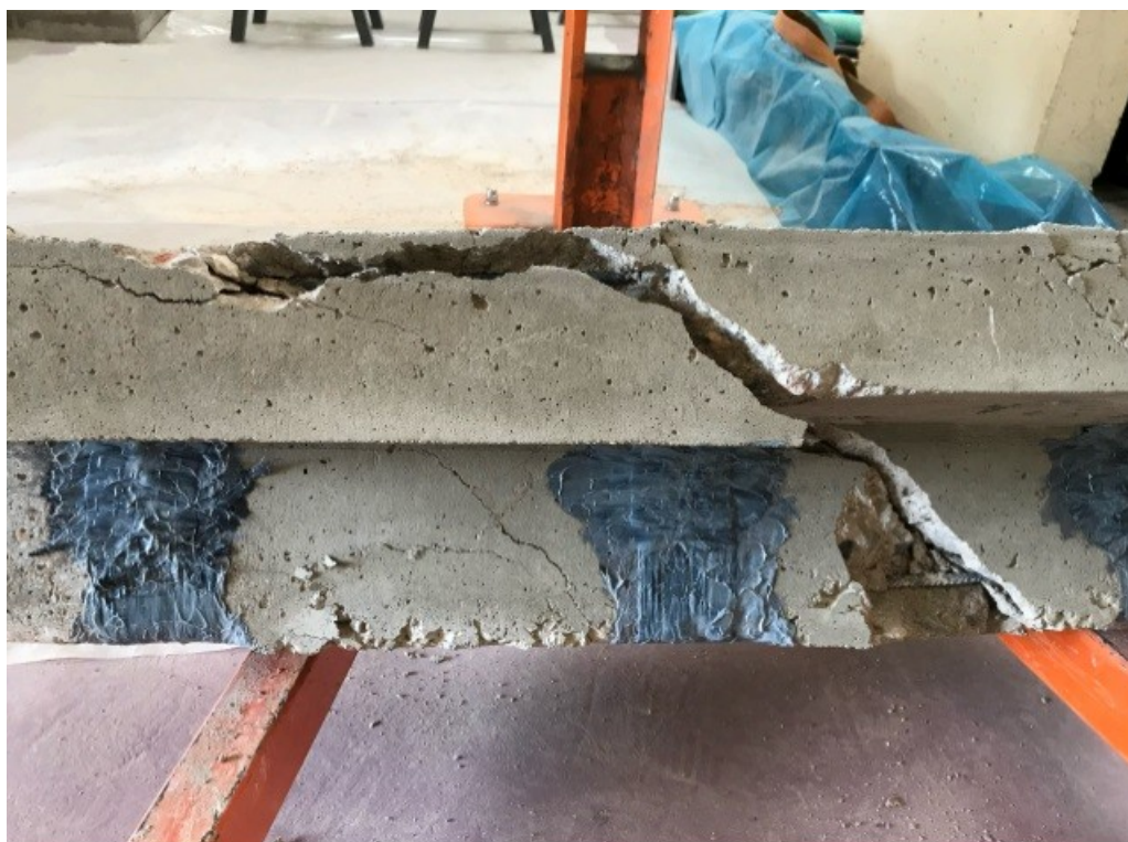
Εικόνα 6.4.1.18 Τελική κατάσταση δοκιμίου μετά τη φόρτιση κατά το 2 ο πείραμα
