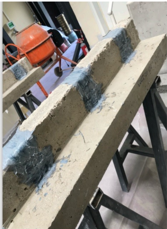
Εικόνα 6.4.1.7 Δοκίμιο μετά την τοποθέτηση του FRP
