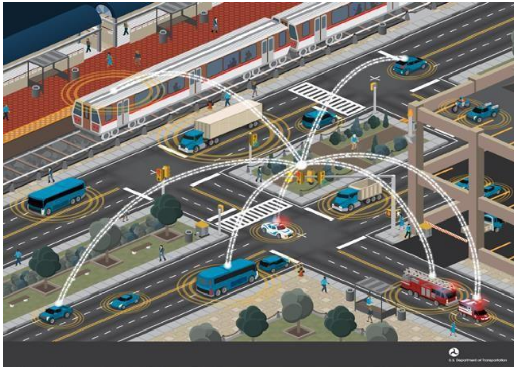
Εικόνα 3: Παράδειγμα συνεργασίας οχημάτων με την υποδομή της οδού (V2I)
