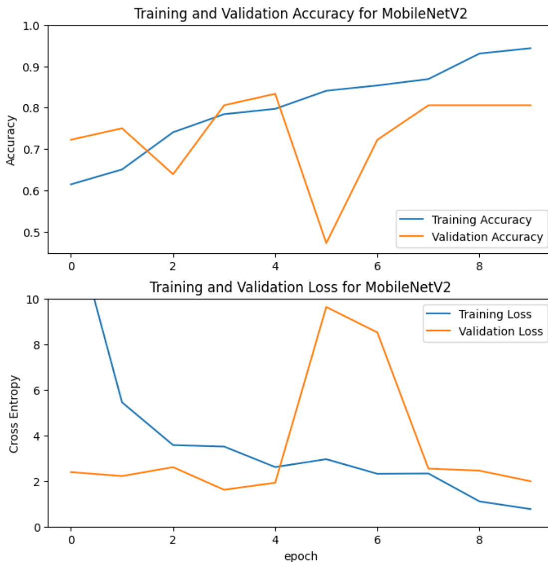
Εικόνα 3.19. Διάγραμμα ακρίβειας, σφάλματος- εποχής για τα δεδομένα εκπαίδευσης και ελέγχου για το mobilenetv2.
