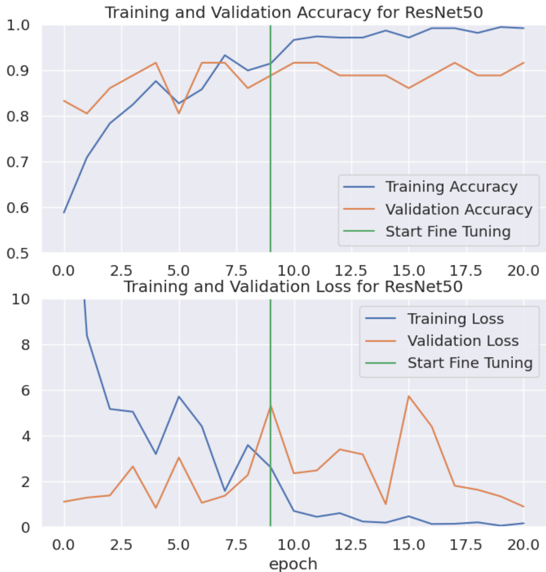
Εικόνα 3.28. β) Γραφική αναπαράσταση της ακρίβειας και του σφάλματος για τα δεδομένα εκπαίδευσης και ελέγχου ανά εποχή πριν και μετά το fine tuning για το μοντέλο ResNet50.
