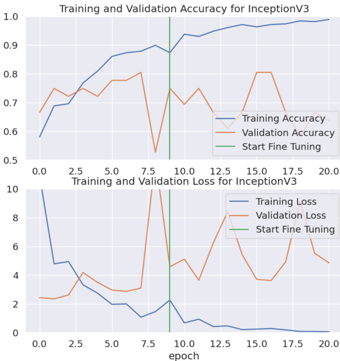
Εικόνα 3.28. γ) Γραφική αναπαράσταση της ακρίβειας και του σφάλματος για τα δεδομένα εκπαίδευσης και ελέγχου ανά εποχή πριν και μετά το fine tuning για το μοντέλο Inception V3.
