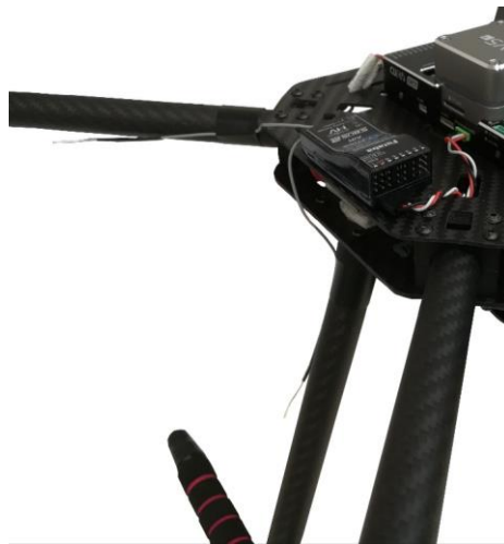
Εικόνα 37: Ο δέκτης τηλεκατεύθυνσης τοποθετημένος δεξιά του ελεγκτή πτήσης και με τις κεραίες να σχηματίζουν γωνία 90^\circ .
