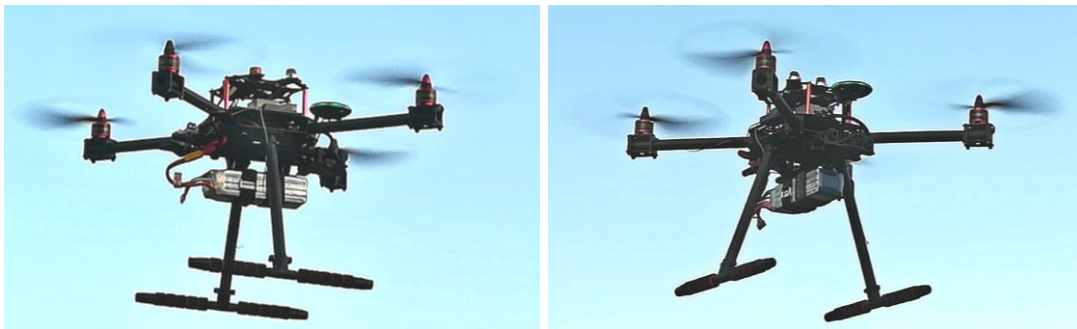
Εικόνα 134: Πτήση του τετρακόπτερου κατά την διάρκεια δοκιμής για την μέτρηση των τιμών συγκέντρωσης των αερίων σε συγκεκριμένο σημείο ενδιαφέροντος.
