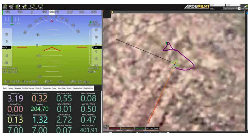
Εικόνα 135: Χειροκίνητος έλεγχος και απογείωση του τετρακόπτερου σε λειτουργία AltHold.
