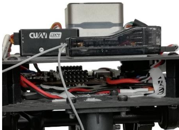
Εικόνα 44: Σύνδεση των καλωδίων σήματος (PWM) στον ελεγκτή πτήσης.
