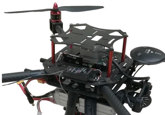
Εικόνα 109: Η βάση από ανθρακόνημα για την τοποθέτηση του συστήματος μέτρησης της ποιότητας του αέρα.
