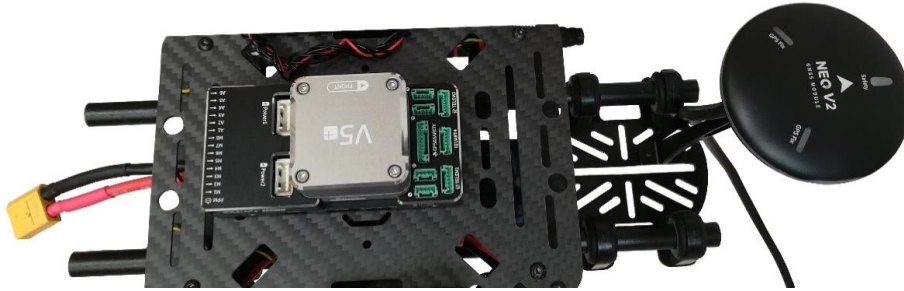
Εικόνα 36: Τοποθέτηση ελεγκτή πτήσης στο κέντρο της βάσης από ανθρακόνημα και με κατεύθυνση ίδια με αυτή του δέκτη GNSS.
