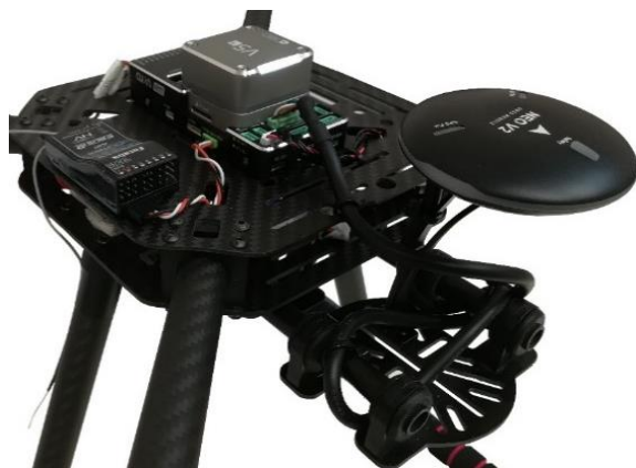
Εικόνα 42: Συνδεσμολογία του δέκτη GNSS, της τηλεκατεύθυνσης και της τηλεμετρίας με τον ελεγκτή πτήσης.
