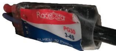
Εικόνα 23: Ο ESC που χρησιμοποιείται για τον έλεγχο του κινητήρα στο τετρακόπτερο.
