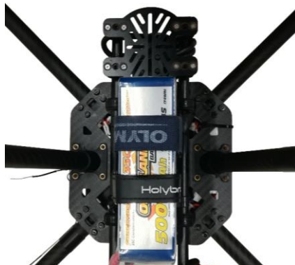
Εικόνα 50: Τοποθέτηση της μπαταρίας με την χρήση μάντων τύπου Velcro.
