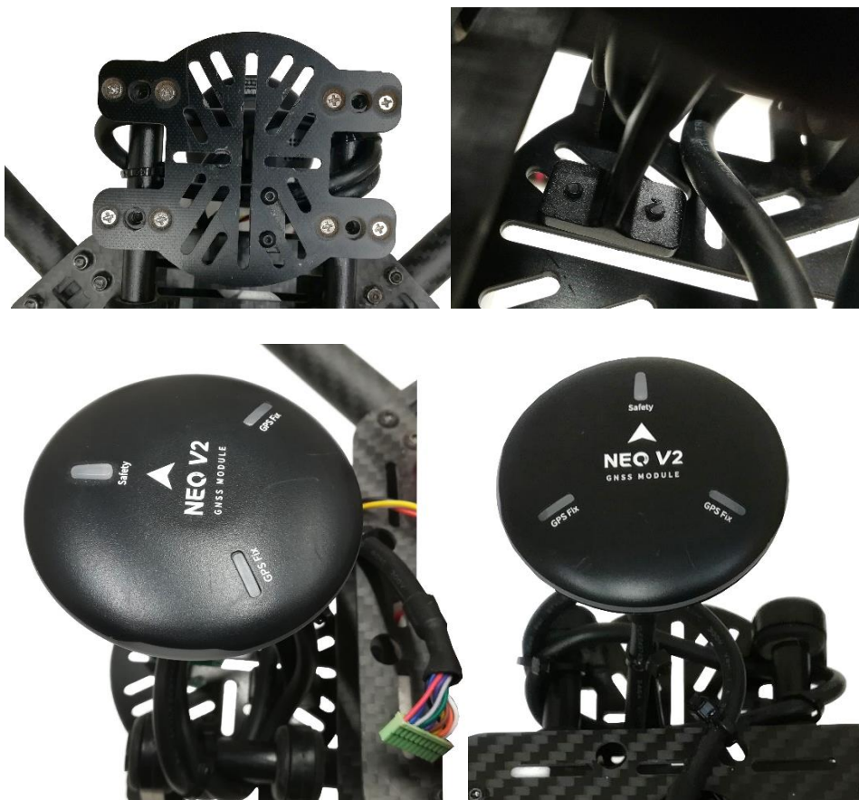
Εικόνα 35: Ο δέκτης GNSS τοποθετημένος στην μεταλλική βάση που έχει στερεωθεί στην βάση από ανθρακόνημα.
