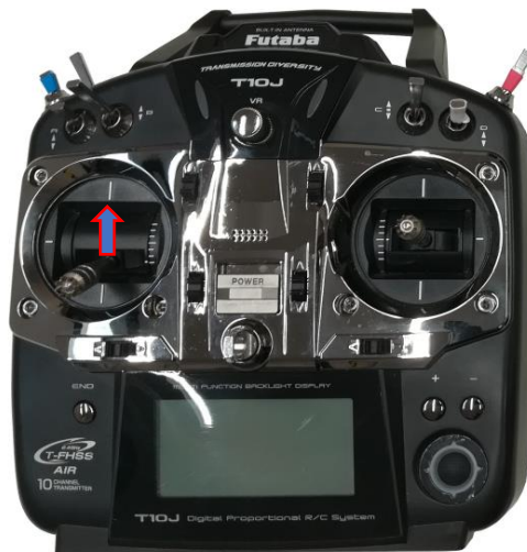
Εικόνα 86: Μετακίνηση του μοχλού Throttle/Yaw προς τα επάνω για τον χειρισμό του Throttle.
