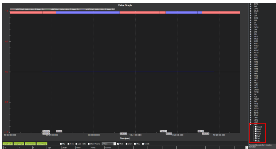
Σχήμα 25: Γραφική παράσταση με τις τιμές των δεδομένων Clip0, Clip1 και Clip2 του τετρακόπτερου να είναι μηδενικές.
