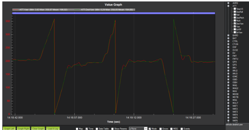
Σχήμα 32: Σχέση μεταξύ της απόκρισης εξόδου και της επιθυμητής εισόδου για το Yaw σε λειτουργία πτήσης AltHold.
