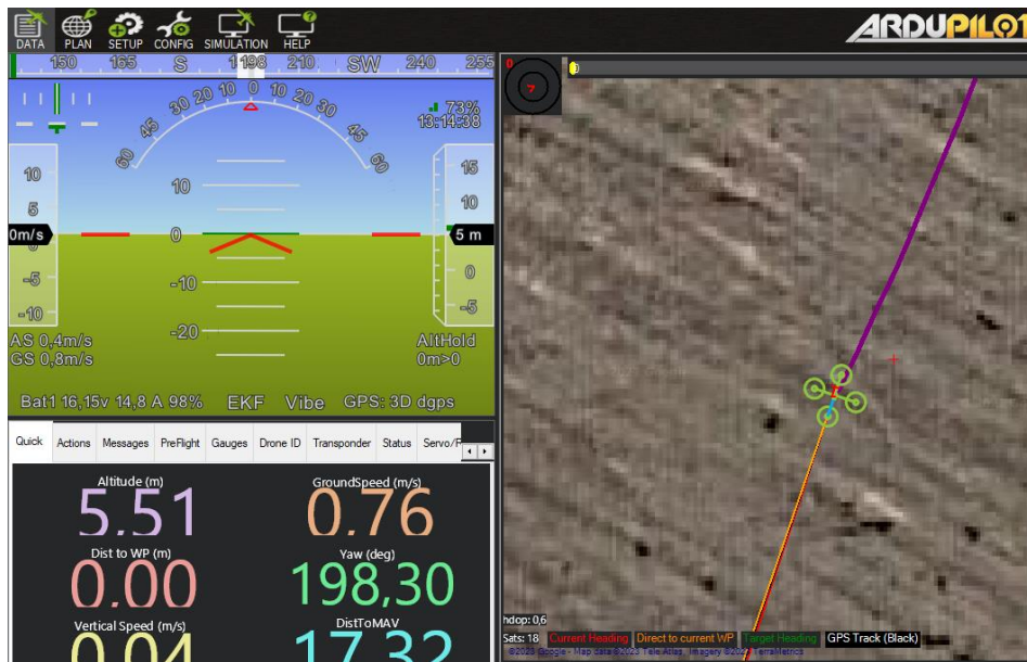
Εικόνα 123: Εκτέλεση πτήσης του τετρακόπτερου σε λειτουργία AltHold για την ρύθμιση του ελεγκτή υψομέτρου.
