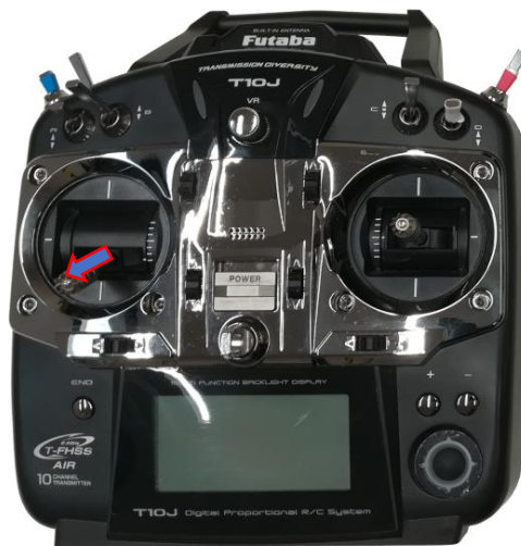
Εικόνα 87: Θέση του μοχλού Throttle/Yaw για Disarm.
