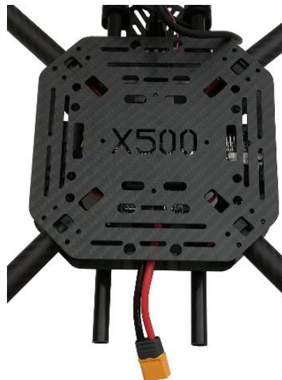
Εικόνα 30: Τοποθέτηση των βραχιόνων στις βάσεις από ανθρακόνημα με την χρήση των πλαστικών στηριγμάτων σχήματος U.
