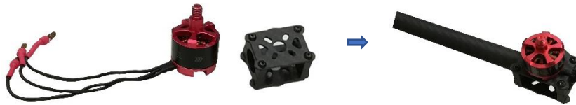
Εικόνα 22: Συναρμολόγηση του βραχίονα και τοποθέτηση του κινητήρα.
