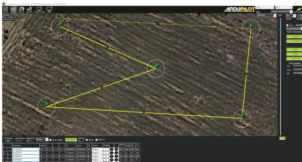
Εικόνα 139: Σχεδιασμός της αυτόνομης αποστολής που θα εκτελέσει το τετρακόπτερο για τον έλεγχο των τιμών συγκέντρωσης των αερίων σε συγκεκριμένα σημείο ενδιαφέροντος.
