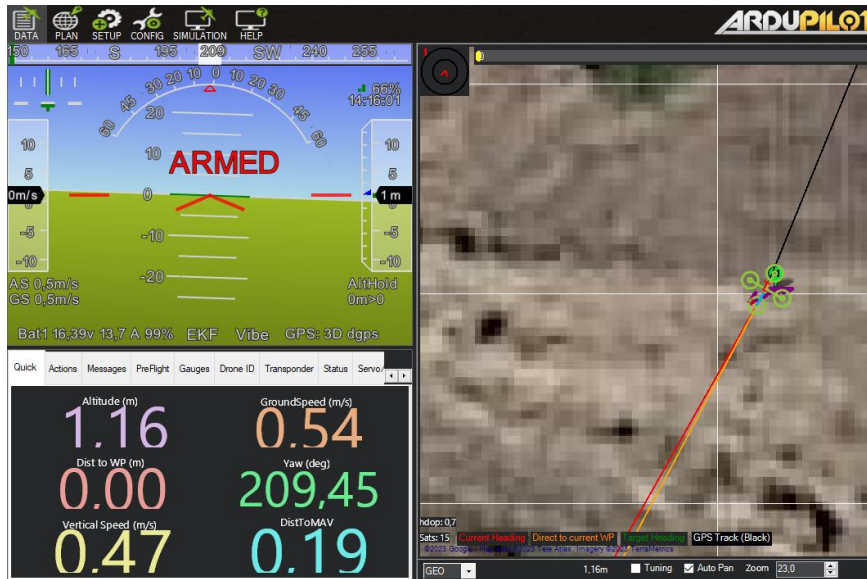
Εικόνα 106: Δοκιμαστική πτήση του τετρακόπτερου σε λειτουργία AltHold.
