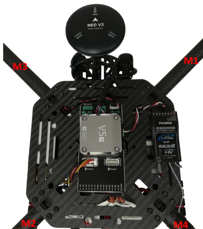
Εικόνα 45: Συνδεσμολογία των ηλεκτρονικών συσκευών με τον ελεγκτή πτήσης και αρίθμηση των κινητήρων για την σύνδεση τους στις αντίστοιχες θέσεις M1-M4 του ελεγκτή πτήσης.
