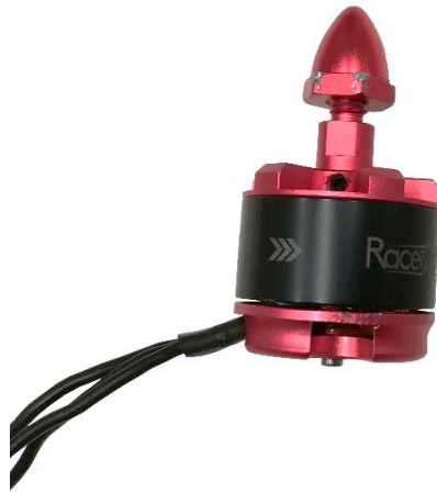
Εικόνα 46: Τοποθέτηση της ειδικής κεφαλής στο σπείρωμα του άξονα του κινητήρα.
