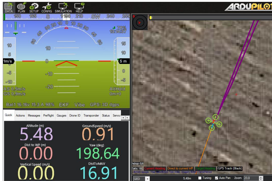
Εικόνα 108: Πτήση του τετρακόπτερου σε λειτουργία AltHold για την αυτόματη ρύθμιση της τιμής της παραμέτρου MOT_THST_HOVER.
