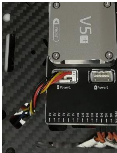
Εικόνα 40: Σύνδεση της τροφοδοσίας του ελεγκτή πτήσης στην θύρα Power1.
