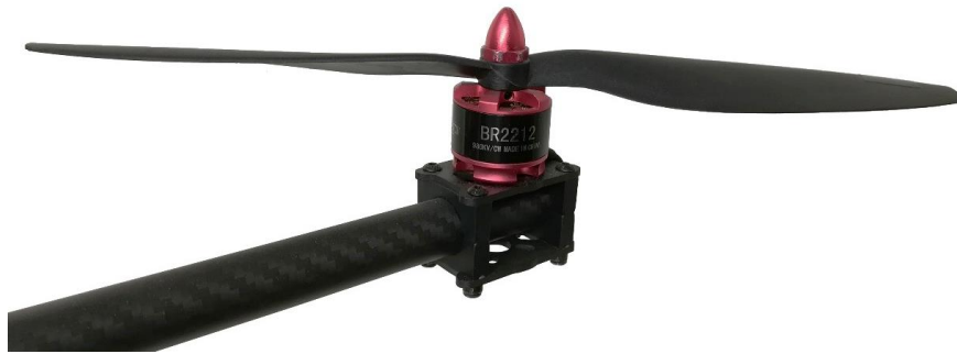
Εικόνα 47: Τοποθέτηση έλικα σε κινητήρα CW.
