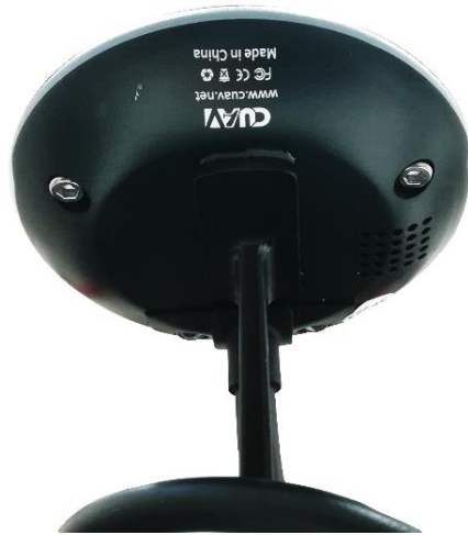
Εικόνα 34: Ο δέκτης GNSS τοποθετημένος με ταινία διπλής όψευς πάνω στην μεταλλική βάση.
