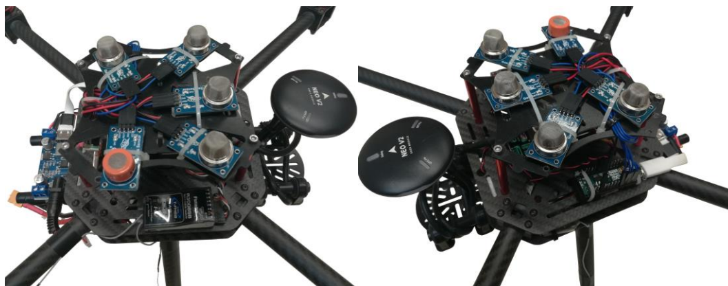
Εικόνα 110: Το ολοκληρωμένο τετρακόπτερο με το ενσωματωμένο σύστημα μέτρησης της ποιότητας του αέρα.
