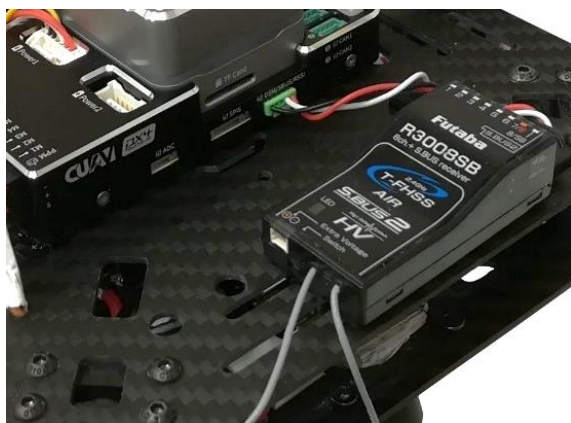
Εικόνα 43: Σύνδεση του δέκτη της τηλεκατεύθυνσης με τον ελεγκτή πτήσης.
