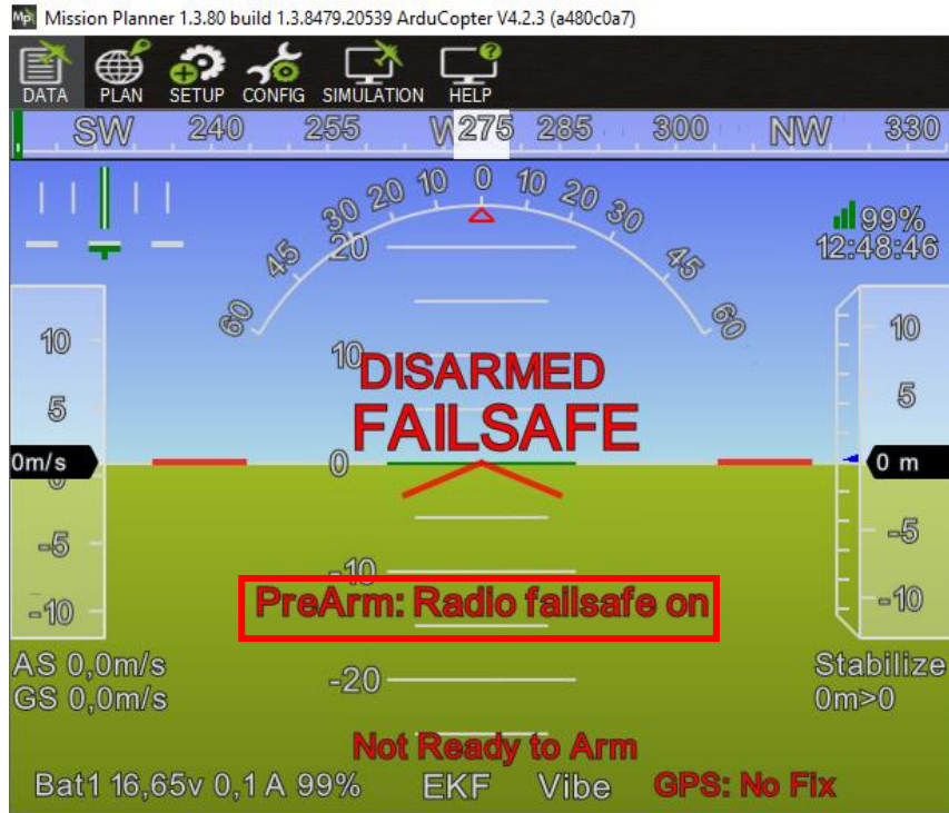
Εικόνα 94: Έλεγχος λειτουργίας του FailSafe της τηλεκατεύθυνσης με δοκιμή της απενεργοποίησης του χειριστηρίου.
