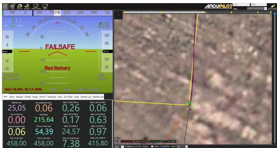
Εικόνα 143: Εκτέλεση της αυτόνομης αποστολής στο τετρακόπτερο για τον έλεγχο των τιμών συγκέντρωσης των αερίων σε συγκεκριμένο σημείο ενδιαφέροντος.
