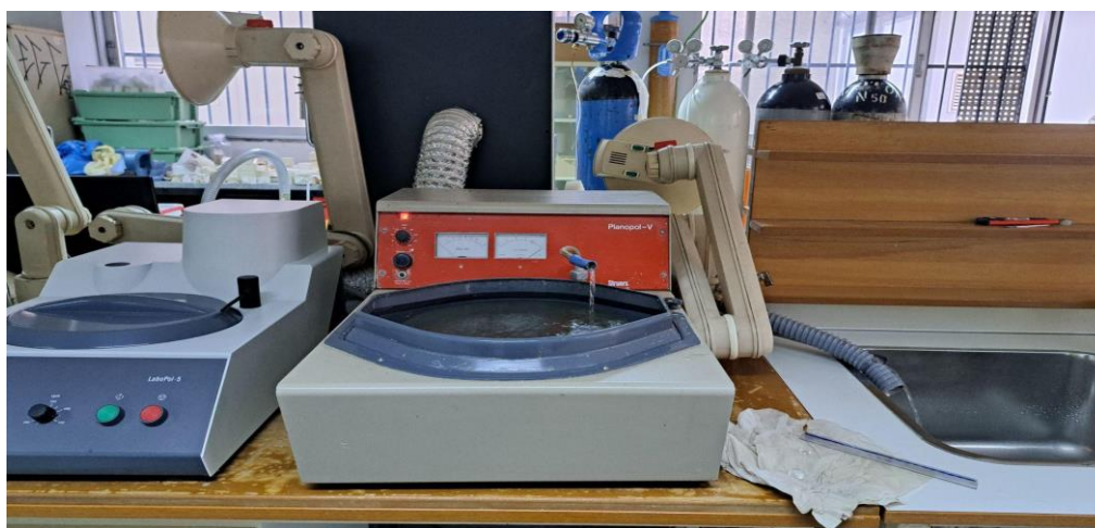
Εικ. 44: Το μηχάνημα λείανσης Planopol V της εταιρείας Struers ©Πανεπιστήμιο Δυτικής Αττικής, Πτυχιακή εργασία, ΠΑΔΑ, Τσαμποδήμου Δήμητρα
