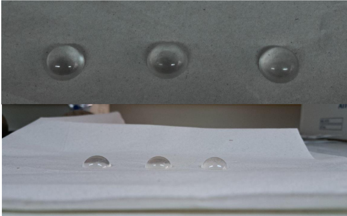
Εικ. 42, 43: Αποτελέσματα δειγμάτων ρητίνης από καλούπι σιλικόνης ©Πανεπιστήμιο Δυτικής Αττικής, Πτυχιακή εργασία, ΠΑΔΑ, Τσαμποδήμου Δήμητρα
