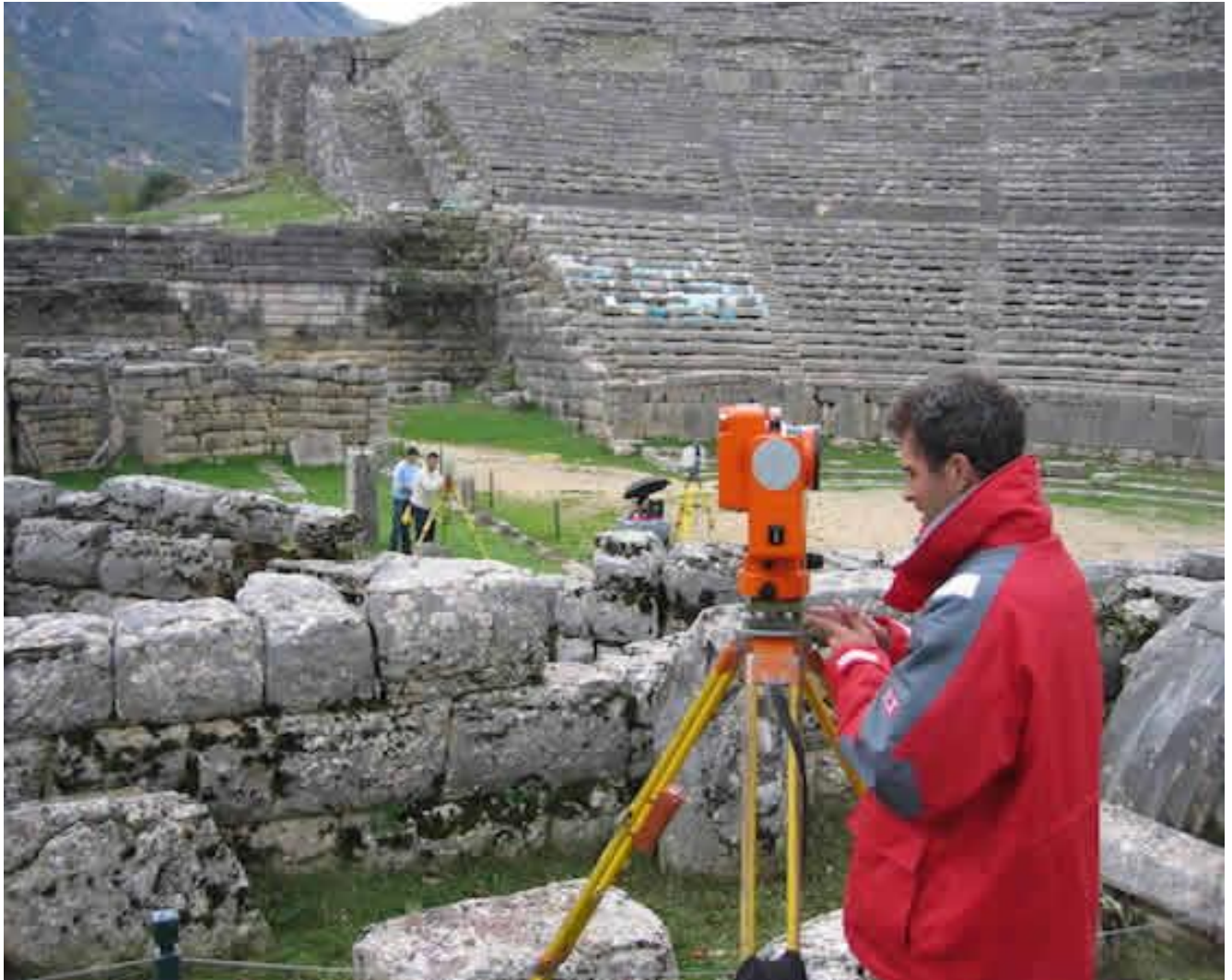
Εικόνα 2 Τοπογραφική αποτύπωση μνημείου με χρήση γεωδαιτικού σταθμού
