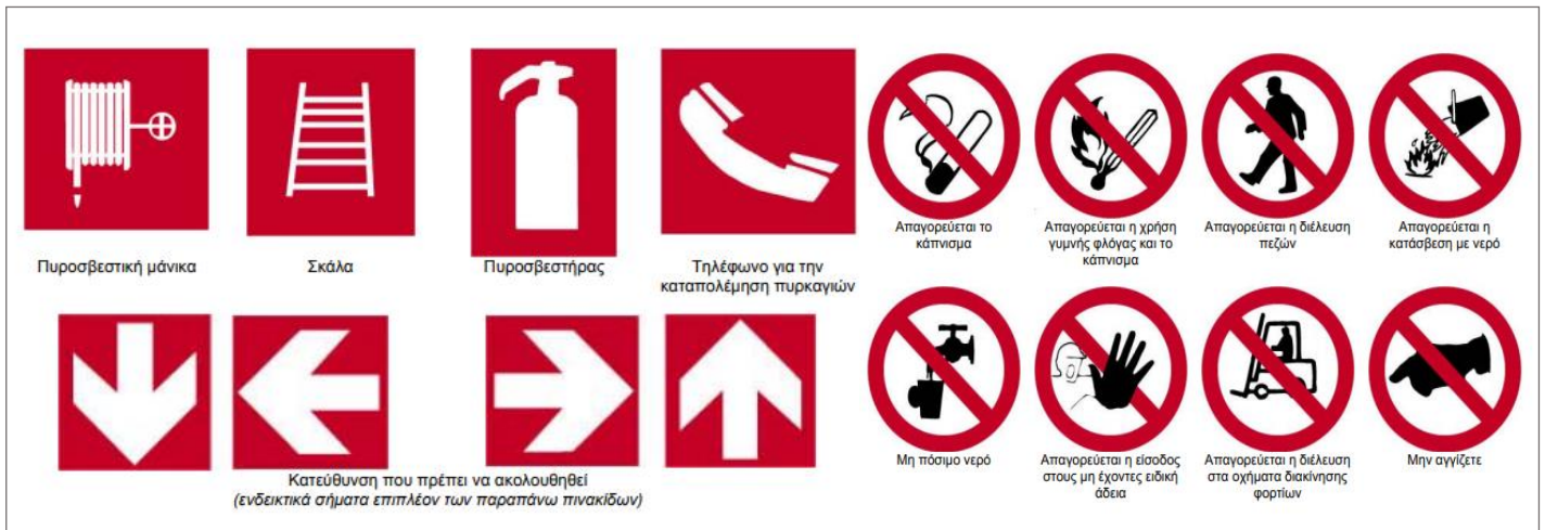
Εικόνα 2: Σήμανση κόκκινου χρώματος (Π.Δ 105/1995 ΦΕΚ 67/Α/10-4-1995)
