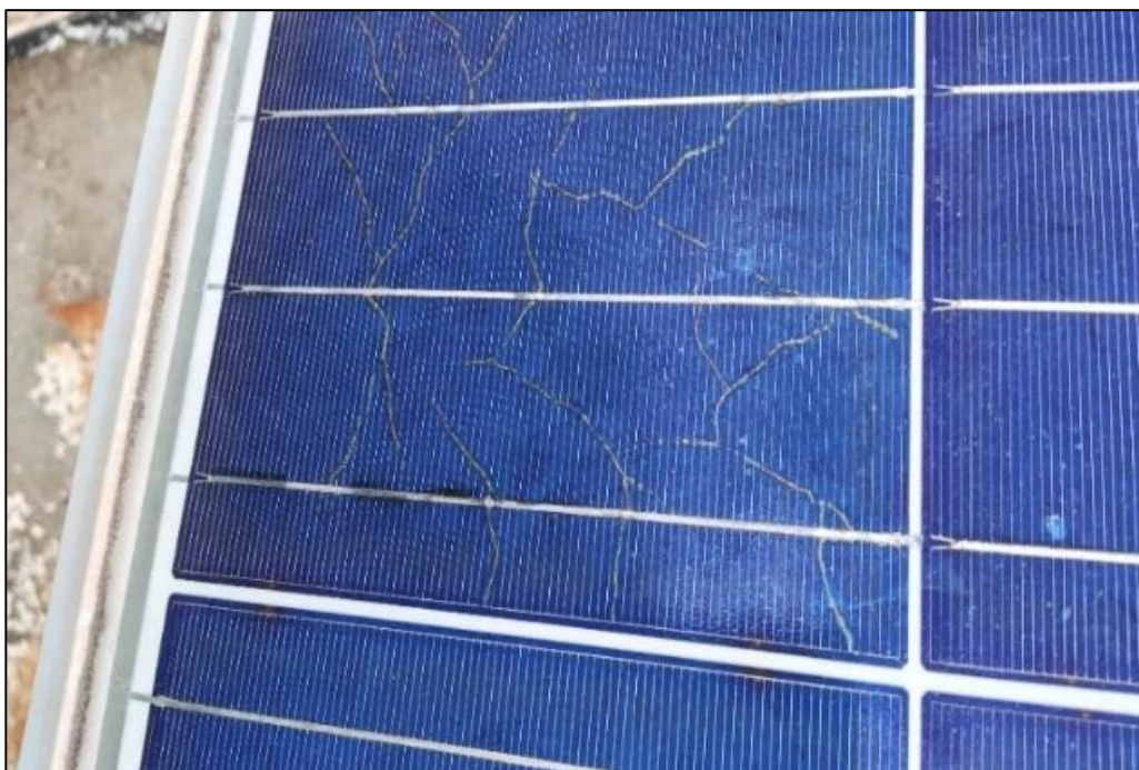
Εικόνα 24: Ραγίσματα στην επιφάνεια του Φ/Β
