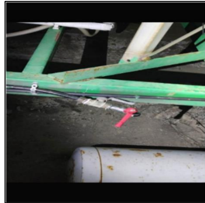
Εικόνα 26: Έξοδος νερού ψύξης.
