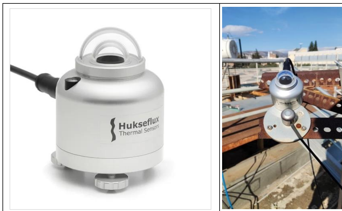
Εικόνα 32: Πρότυπο πυρανόμετρο Hukseflux SR15-A1 (αριστερά) & διάταξη βαθμονόμησης (δεξιά)
