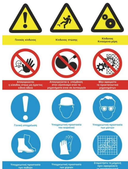
[25] Σήμανση χώρων αποθήκευσης και επεξεργασίας
