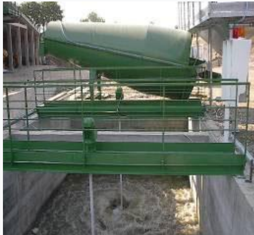
Εικόνα 1: Ανακύκλωση τύπου «βαρέλα» με διπλή δεξαμενή
