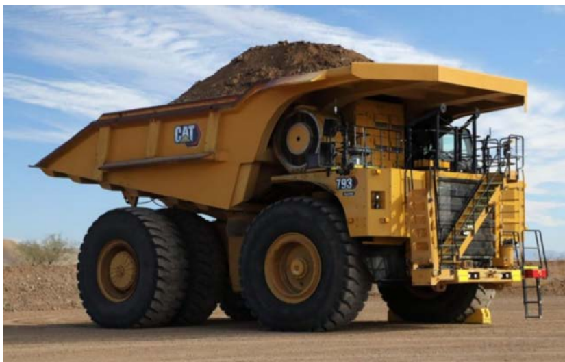
Εικόνα 39 Πρώτο ηλεκτρικό φορτηγό (793)
