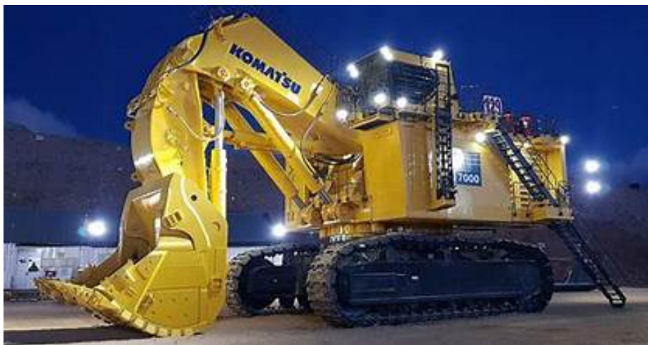
Εικόνα 62 Εκσκαφέας με μετωπικό κάδο
