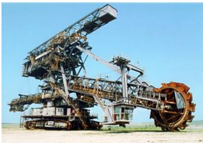
Εικόνα 71 Εκσκαφέας με καδοτροχό
