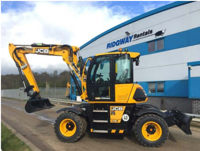
Εικόνα 63 Εκσκαφέας με ανεστραμμένο κάδο
