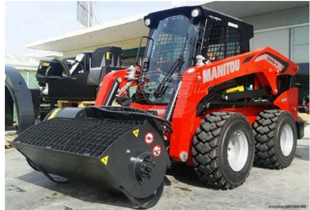
Εικόνα 110 Φορτωτάκι με μίξερ σκυροδέματος
