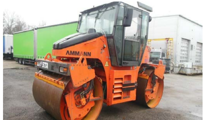
Εικόνα 139 Οδοστρωτήρας με δύο τύμπανα
