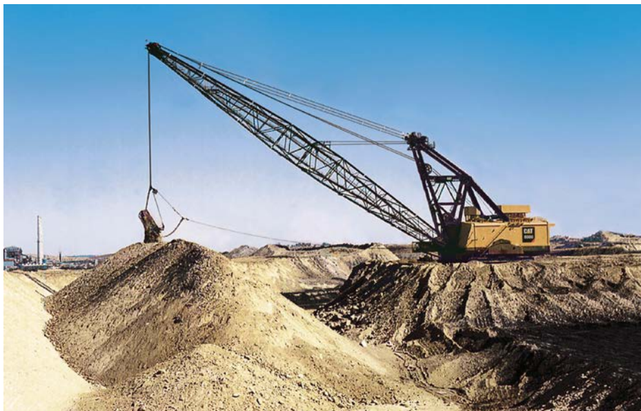
Εικόνα 65 Εκσκαφέας με συρόμενο κάδο
