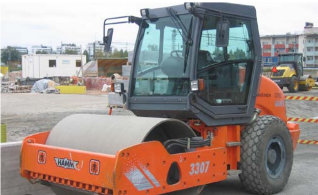
Εικόνα 138 Οδοστρωτήρας με ένα τύμπανο
