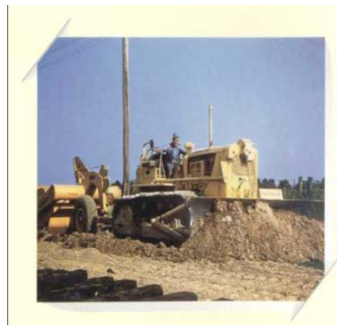
Εικόνα 28 Πρωθητής D7 με μαχαίρι και scraper
