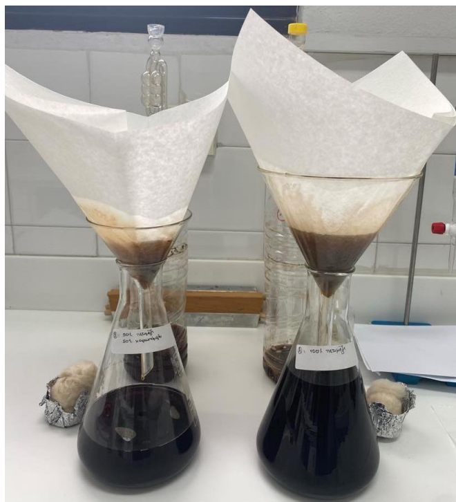
Εικόνα 3.17: Διήθηση και καθαρισμός δειγμάτων την 30η ημέρα
