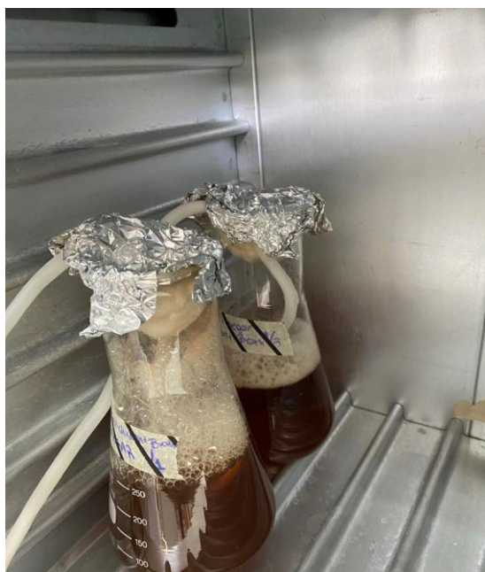
Εικόνα 3.13: Κωνικές φιάλες, με V1 και V3 μαζί με BHI broth και διοχέτευση οξυγόνου
