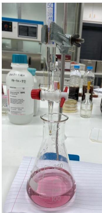
Εικόνα 3.8: Διαδικασία ογκομέτρησης για προσδιορισμό οξύτητας δειγμάτων, έχοντας φτάσει στο τελικό σημείο (ροζ χρώμα)
