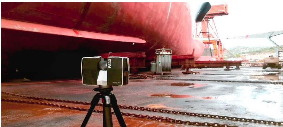
Εικόνα 4: Τρισδιάστατη σάρωση πλοίου με επίγειο λέιζερ σαρωτή [17].
