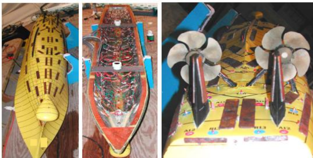
Εικόνα 35: Παράδειγμα ενός μοντέλου μικρής κλίμακας που χρησιμοποιείται στη μοντελοποίηση φυσικής κλίμακας. (Πηγή: DeGiorgi, V.G., & Hogan, E. A., 2005)
