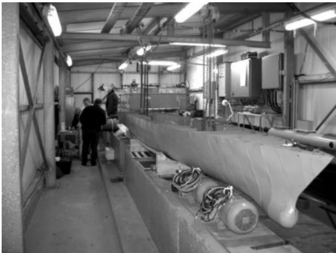
Εικόνα 34: Παράδειγμα ενός μοντέλου μικρής κλίμακας που χρησιμοποιείται στη μοντελοποίηση φυσικής κλίμακας. (Πηγή: Arendt, H.F., 2005).
