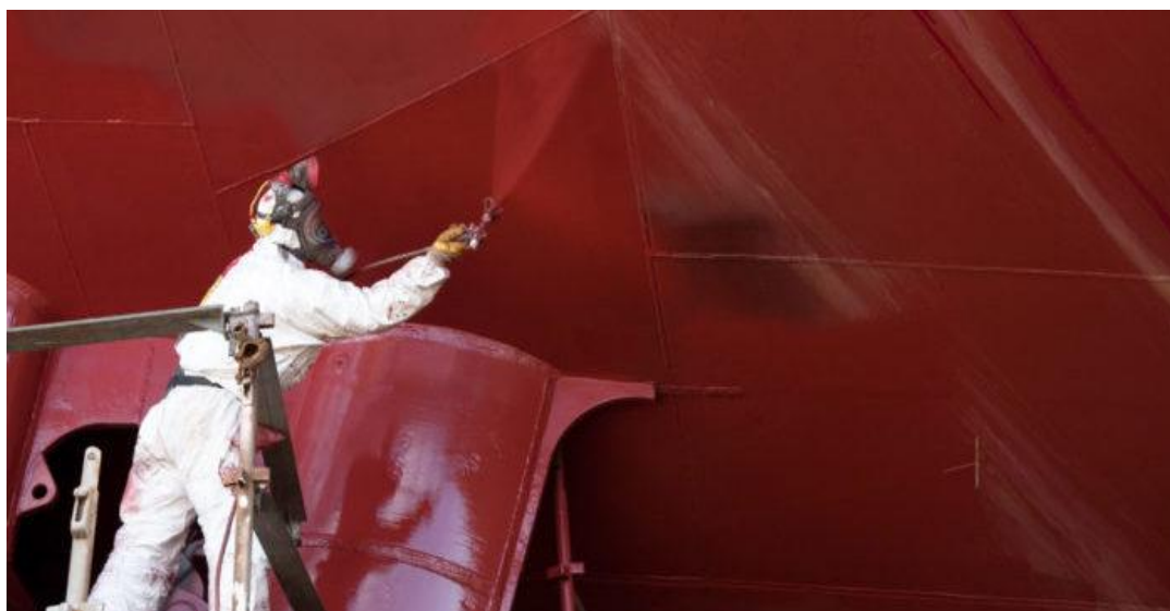
Εικόνα 3:Εργασίες εφαρμογής οργανικής επίστρωσης σε γάστρα πλοίου. (Πηγή: https://safety4sea.com/hull-coatings-technologies/ )
