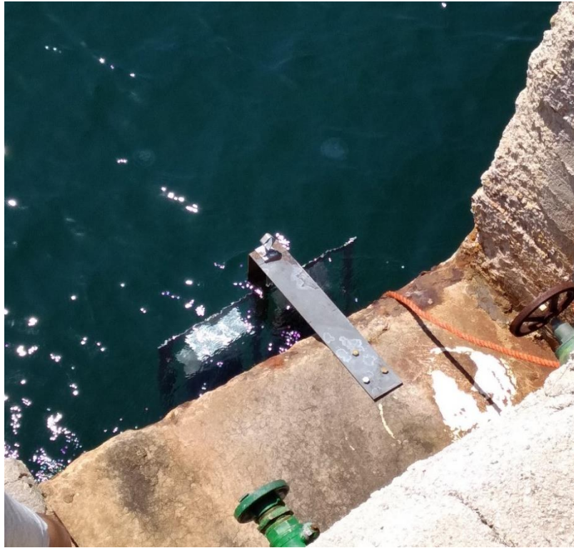
Εικόνα 57. Τα δοκίμια στερεωμένα στο πλαίσιο και βυθισμένα στο θαλασσινό νερό
