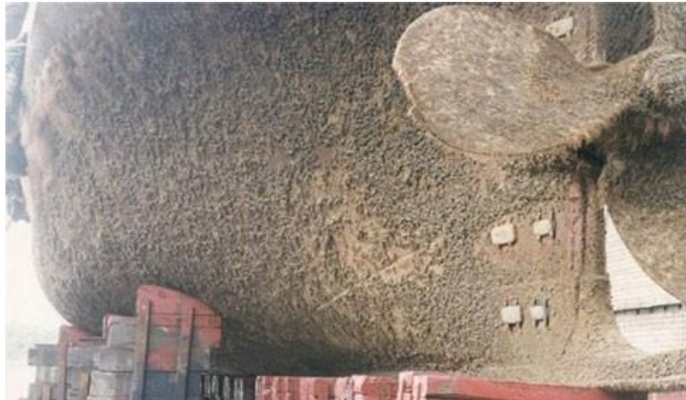
Εικόνα 4. Βιοσυσσώρευση σε γάστρα πλοίου
