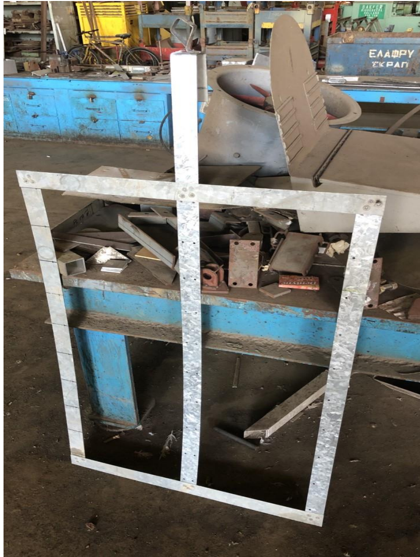
Εικόνα 52. Η κατασκευή του πλαισίου για την τοποθέτηση των δοκιμίων
