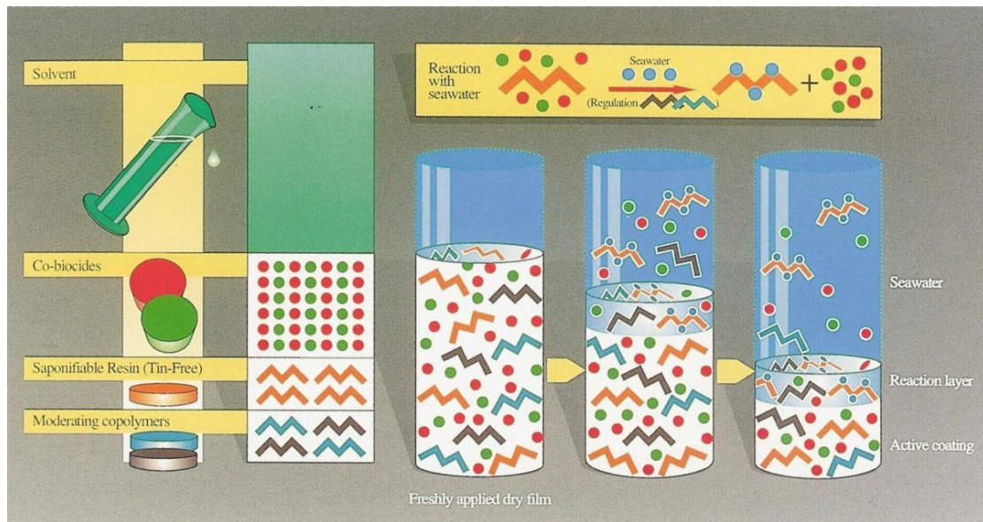
Εικόνα 36. Αναπαράσταση του μηχανισμού δράσης των υφαλοχρωμάτων CDPs με πολυμερή ελεγχόμενης απελευθέρωσης (Tin-free controlled depletion paints-CDPs)
