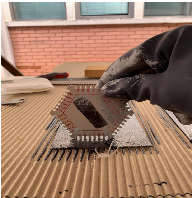
Εικόνα 48. Μέτρηση πάχους υγρού χρώματος
