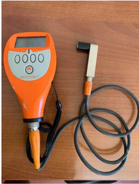
Εικόνα 53. Το παχύμετρο που χρησιμοποιήθηκε για τη μέτρηση του πάχους χρώματος
