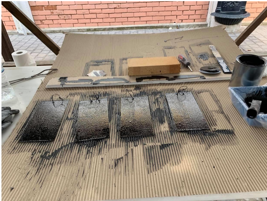
Εικόνα 49. Τα δοκίμια στην τελική μορφή τους μετά την βαφή
