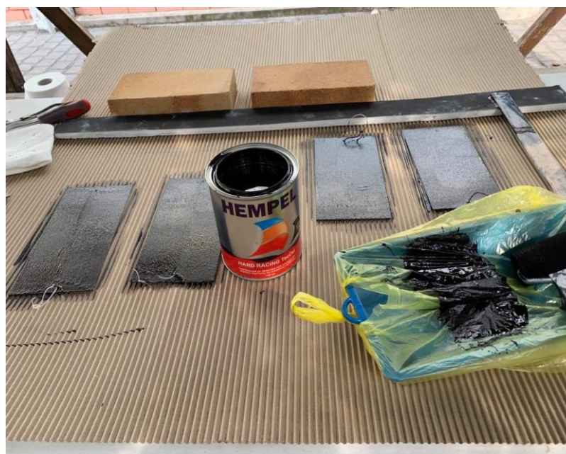
Εικόνα 47. Υλικά και βαφή των δοκιμίων
