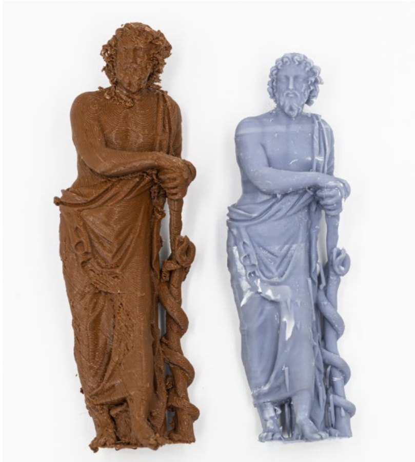
Εικ. 9.18 Εκτύπωση με τεχνολογίες FDM (αριστερά) και SLA resin (δεξιά)
