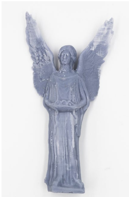
Εικ. 9.38 Εκτύπωση με τεχνολογία SLA (resin)
