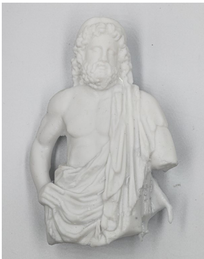
Εικ. 9.24 Εκτύπωση γλυπτού με τεχνολογία SLA (resin)
