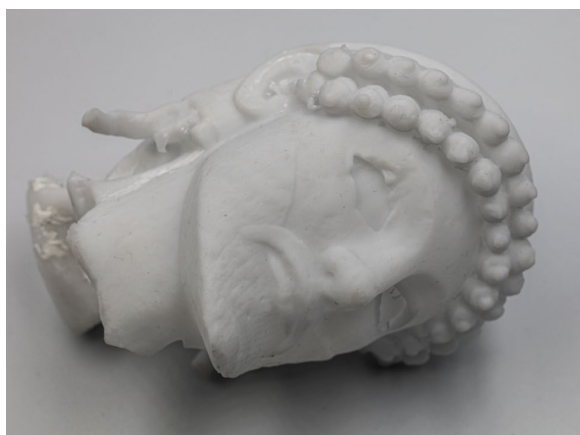
Εικ. 9.15 Εκτύπωση κεφάλι Δία με τεχνολογία SLA (resin)
