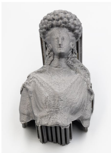
Εικ. 9.8 Εκτύπωση μοντέλου με τεχνολογία FDM (νήμα)
