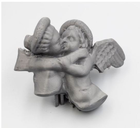
Εικ. 9.11 Εκτύπωση μοντέλου με τεχνολογία FDM.
