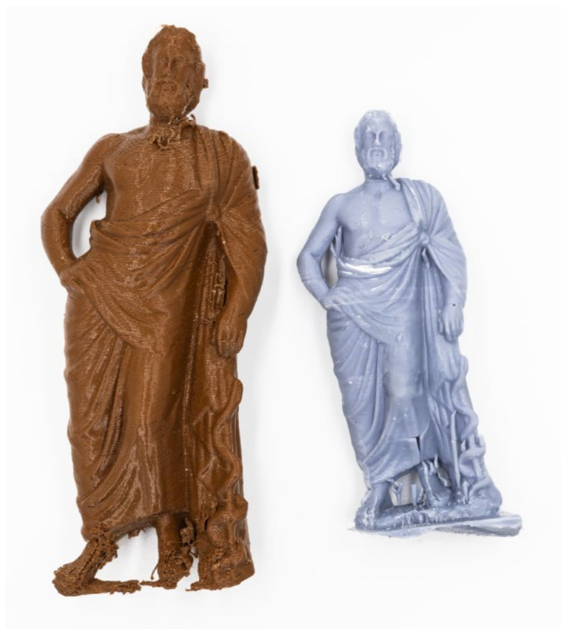
Εικ. 9.21 Εκτύπωση με τεχνολογία FDM (αριστερά) και SLA resin (δεξιά)
