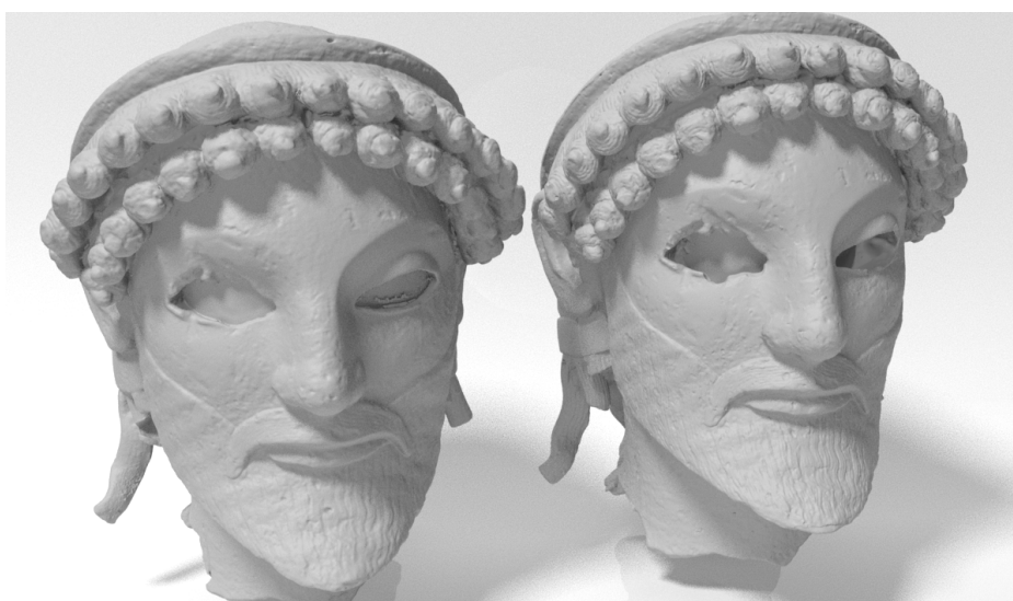
Εικ. 9.16 Σάρωση αντιγράφου με το 3D scanner του ερευνητή αριστερά, Σάρωση πρωτοτύπου με άλλο 3D scanner
