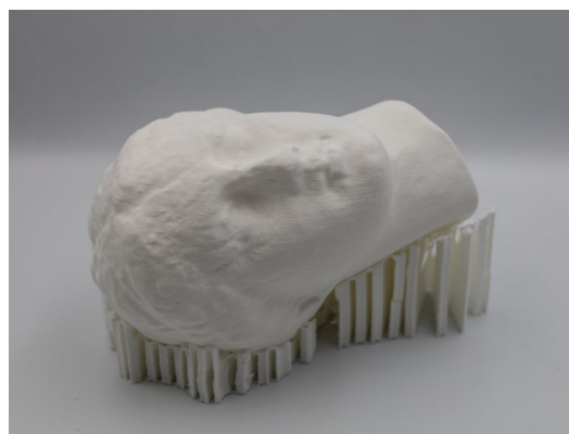
Εικ. 9.3 Αποτέλεσμα εκτύπωσης FDM με λευκό PLA
