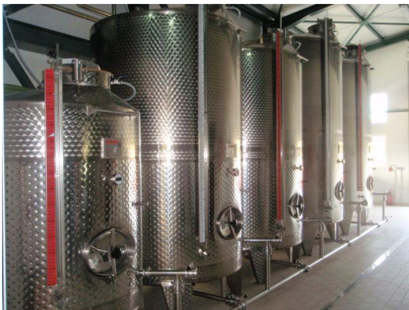
Εικόνα 1.3.12.: Ανοξειδωτες υπέργειες δεξαμενές αποθήκευσης ελαιολάδου.
