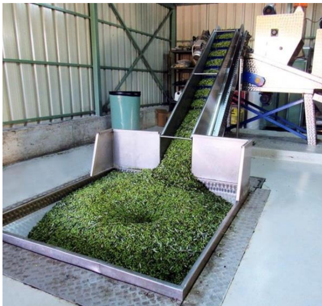
Εικόνα 1.3.8.: Παραλαβή ελαιόκαρπων και μεταφορά στο αποφυλλωτήριο.
