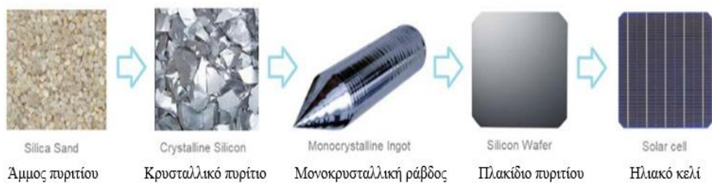
Εικόνα 5.4: Στάδιο παραγωγής φωτοβολταϊκών κελιών [21]
