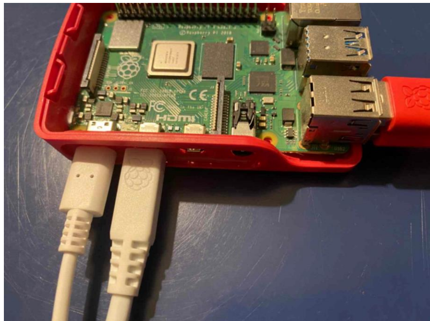
Εικόνα 5.11 Raspberry Pi 4 με συνδεδεμένη την θύρα τροφοδοσίας
