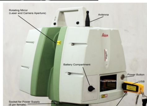
Εικόνα 8: Το εσωτερικό και εξωτερικό μέρος του Leica Scanstation C10 (Walsh, 2015)
