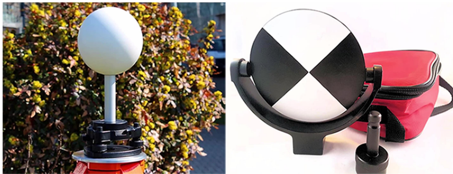
Εικόνα 18: Παραδείγματα ειδικών στόχων https://scantobim.xyz/blog/registration-basics-part-2-target-based-registration/
