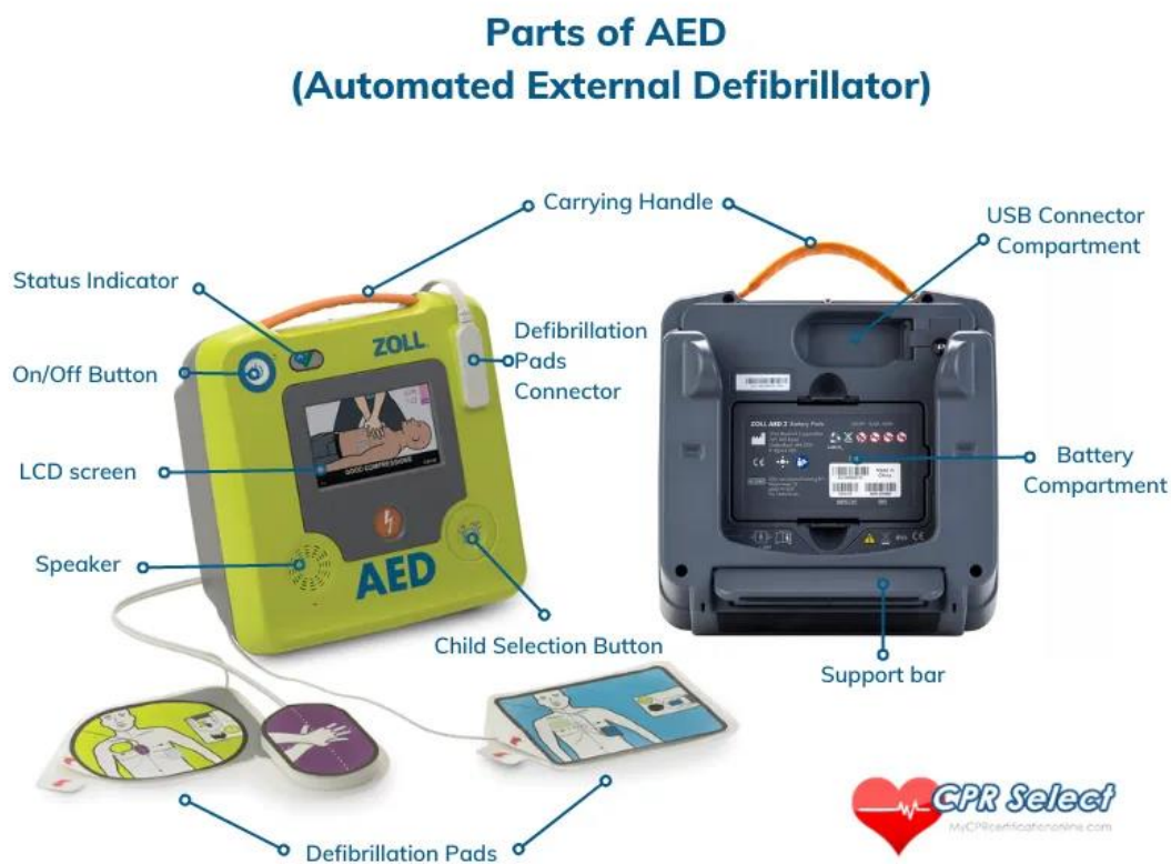
Εικόνα 4.1 Βασικά μέρη-τμήματα ενός πλήρως αυτόματου απινιδωτή [12].
