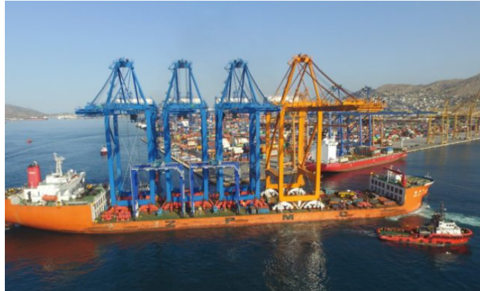
Εικόνα 4 Γερανογέφυρα Φορτοεκφόρτωσης Πλοίων
