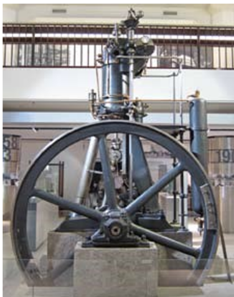
Εικόνα 2: Ο πρώτος κινητήρας που σχεδιάστηκε από τον R.C. Karl Diesel και λειτουργήσε επιτυχώς το 1897 [11]
