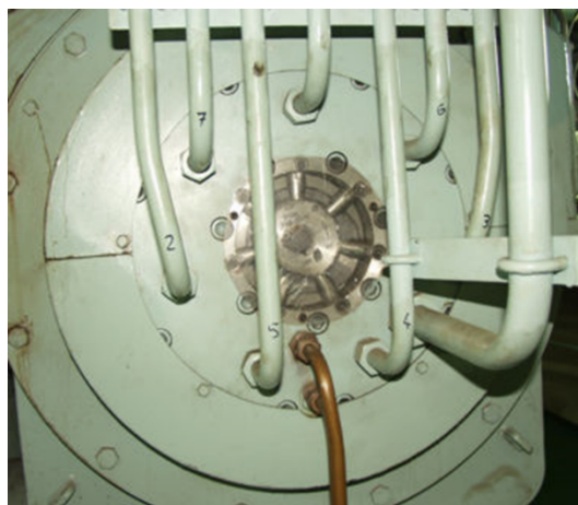
Εικόνα 43: Διανομέας αέρα εκκίνησης
