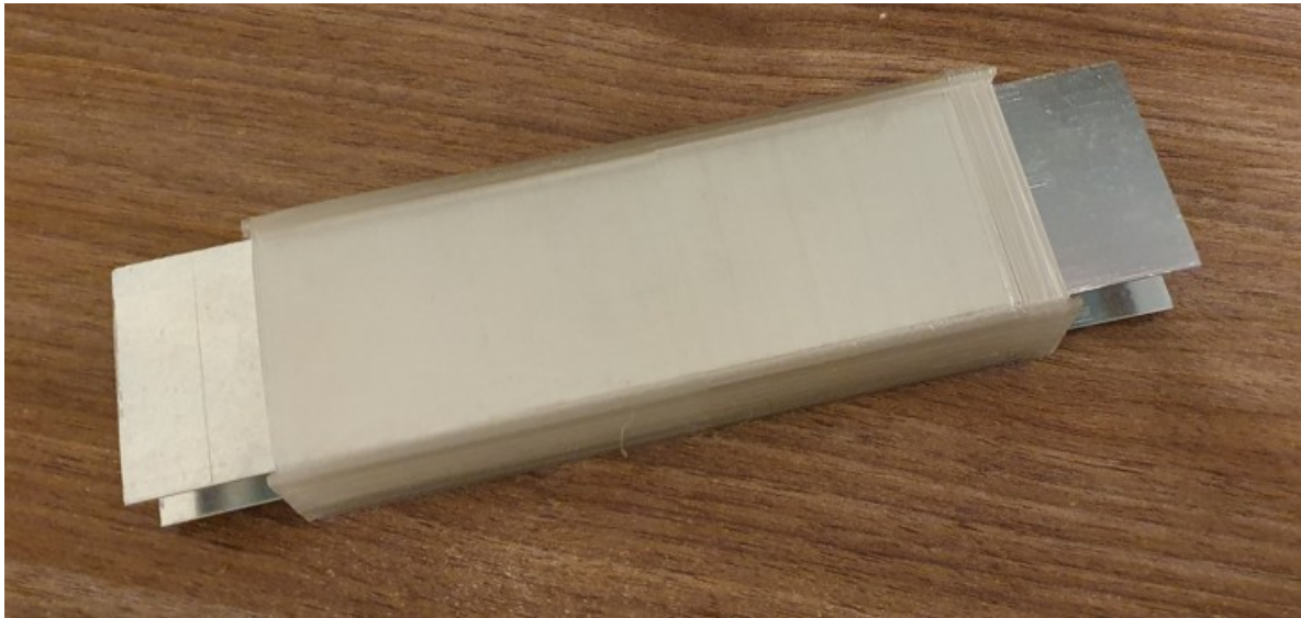
Εικόνα 21: Πρόσοψη θαλάμου με ηλεκτρόδια
