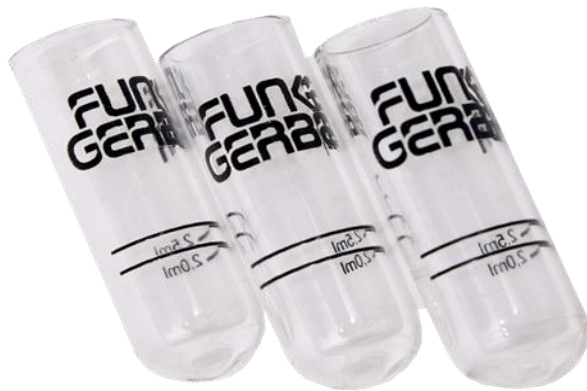
Εικόνα 18: Κυψελίδες κρουσκοπίου από βοριοπυρριτικό γυαλί
