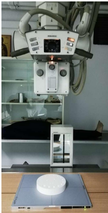
Εικόνα 23. Τοποθέτηση ομοιώματος στην εξεταστέα τράπεζα
