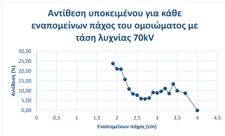
Εικόνα 36. Διάγραμμα αντίθεσης υποκειμένου για κάθε εναπομείνων πάχος του ομοιώματος με τάσης λυχνίας 70kV
