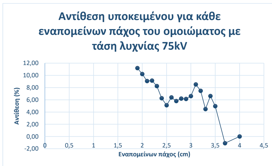
Εικόνα 37. Διάγραμμα αντίθεσης υποκειμένου για κάθε εναπομείνων πάχος του ομοιώματος με τάσης λυχνίας 75kV
