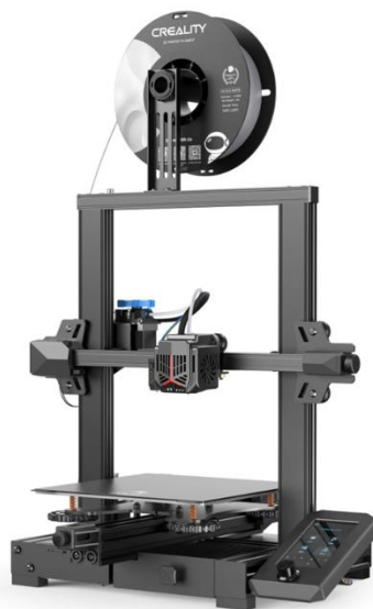
Εικόνα 12. 3D εκτυπωτής Ender-3 V2 Neo της εταιρίας Creality
