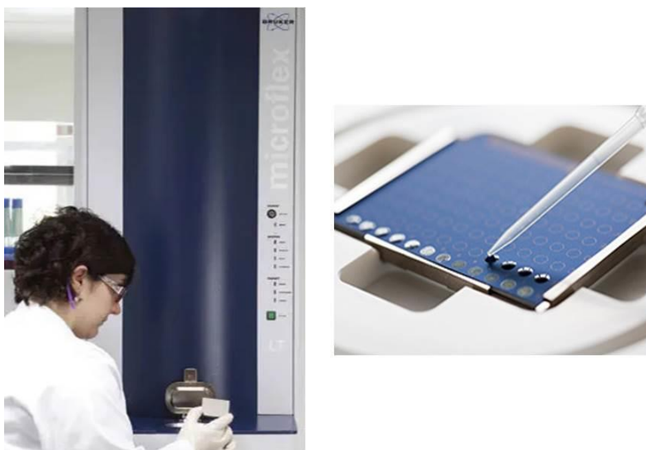
Εικόνα 52. Αναλυτής MALDI Biotyper ® (αριστερά) (253) και ανοξειδωτή πλάκα 96-θέσεων για τη φόρτωση των δειγμάτων (δεξιά) (254).
